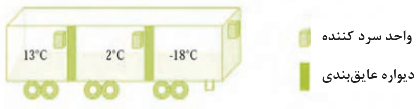
شکل ۲۰- نمای شماتیک از کانتینر با دماهای مختلف پشت سرهم
