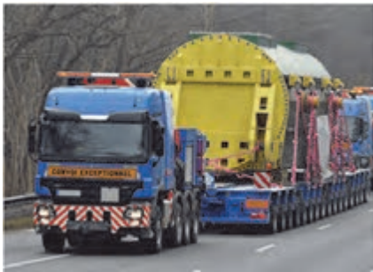
شکل ۱۰- نمونه‌ای از کشنده و یدک (بوژی)
