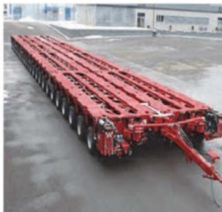
شکل ۱۴- نمونه‌ای از بوژی
