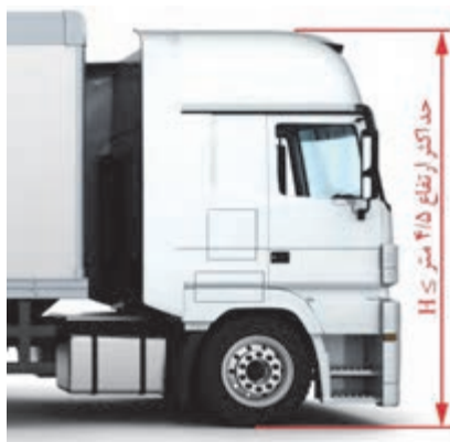
شکل ۴- حداکثر ارتفاع تعیین شده برای وسایل نقلیه
