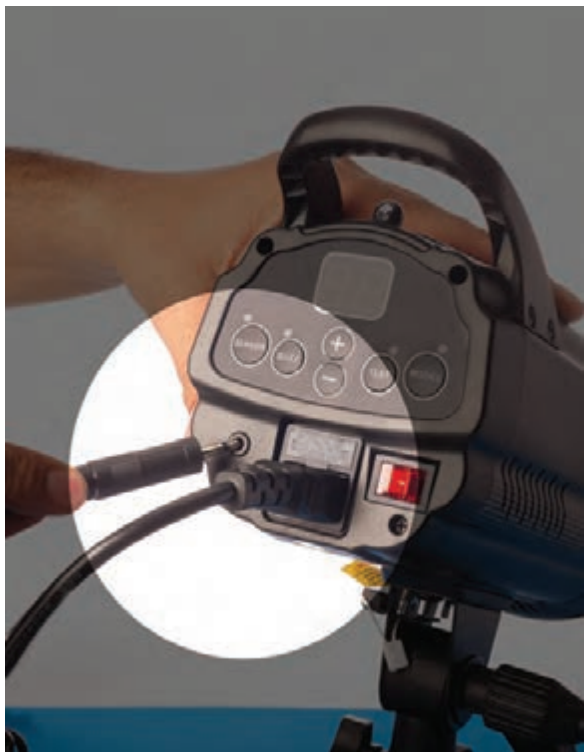
▲ اتصال سیم سینکرون رادیوتریگر به فلاش | تصویر ۱۳۶
