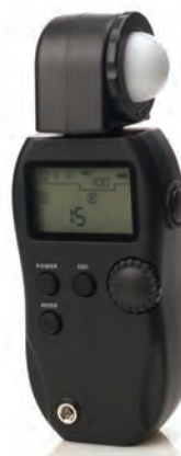
▲ تصویر ۱۸۸ وضعیت کلاهک نورسنج در حالت سنجش ۱۸° درجه برای چند منبع نوری همزمان
