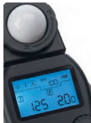
▲ تصویر ۱۹۳ سنجش نور فلاش با اتصال سیم سینکرون
