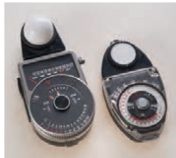
▲ نورسنج دستی عقربه‌ای | تصویر ۵۷
