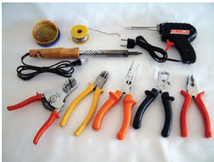
شکل ۹۱-۲- برخی ابزار کارگاه الکترونیک
