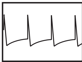
شکل ۱-۱۰۱- تهیهی ولتاژ L' از ترانس سطر
