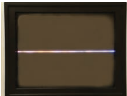
شکل ۲-۴۰- نوسان ساز عمودی از کار افتاده است.
