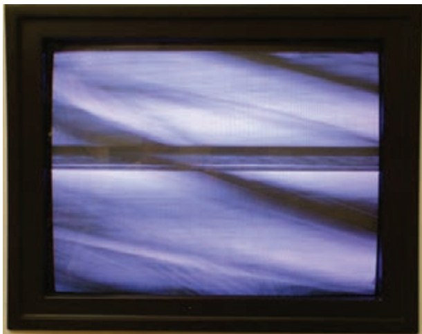
شکل ۴۹-۱- عدم تنظیم فرکانس نوسان ساز افقی
