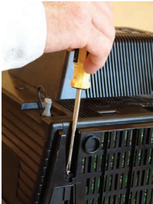
شکل ۲-۴۲- نحوه‌ی باز کردن قاب پشت تلویزیون
