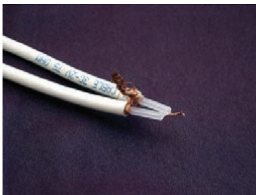
شکل ۱-۶۳- سیم کابل نباید دو تکه باشد.
