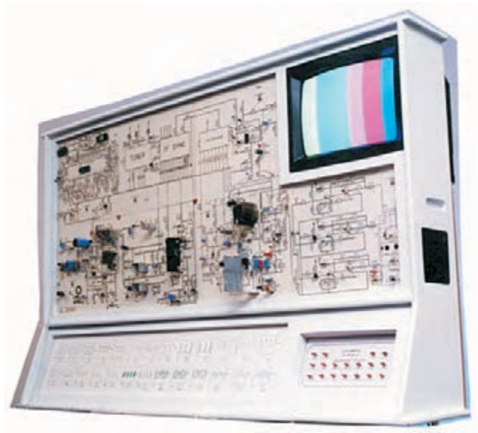
شکل ۳۷-۶ یک نوع گسترده تلویزیون رنگی
