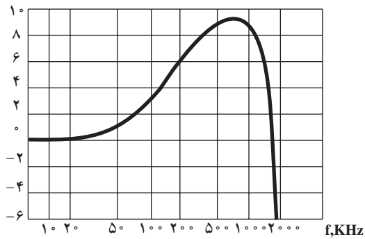
پری امفسایز فرکانس پایین در سیگنال‌های تفاضلی رنگ
