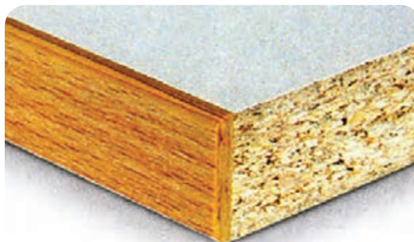
شکل ۴-۲- لبه نئوپان‌ها فاقد زیبایی و صافی هستند.
