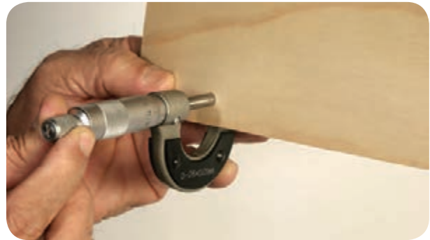
شکل ۷۲-۵ اندازه‌گیری ضخامت روکش با میکرومتر
