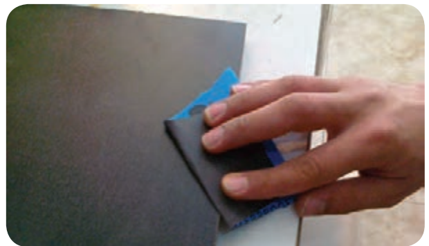
شکل ۴-۳۰ - پرداخت لبه لبه‌های نوار شده با سنباده
