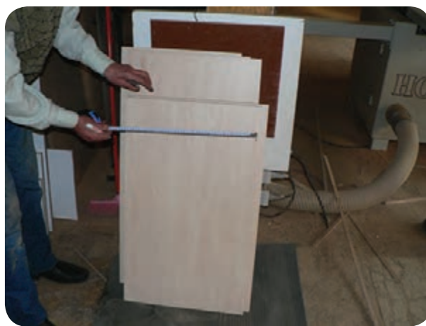
شکل ۱۱۶-۵- کنترل اندازه قطعات آماده شده
