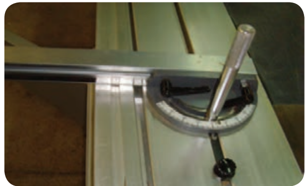
شکل ۵-۵۲- گونیای کوچک قابل تنظیم برای برشکاری
