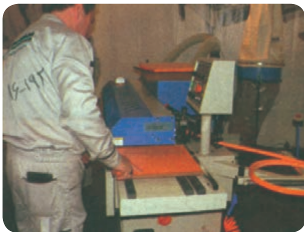
شکل ۱۱۸-۵- نوار چسبانی پی‌وی‌سی با ماشین لبه‌چسبان
