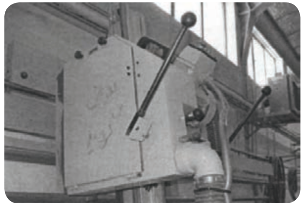
شکل ۳۹-۵- اهرم حرکت اره برای برش
