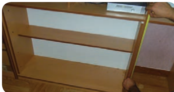
شکل ۱۷۳-۵- اندازه‌گیری برای نصب صفحه زیر کشوها
