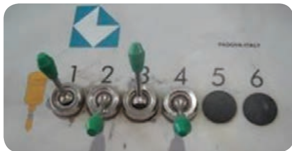
شکل ۳-۶ - کلیدهای بالا و پایین برنده جک‌ها
