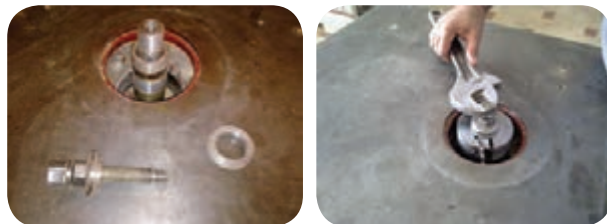
شکل ۲۸-۲- تنظیم کردن تویی در دستگاه فرز
