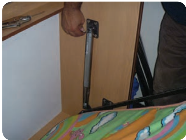
شکل ۵-۱۳۷ تنظیم فشار گاز سیلندر برای تعادل تختخواب
