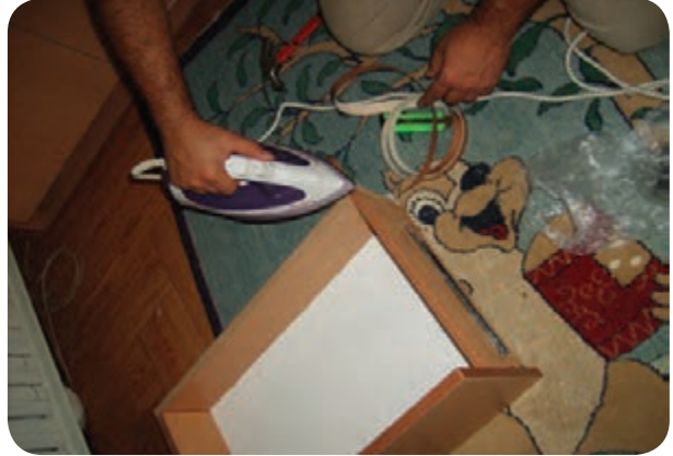
شکل ۱۵۴-۵- نوار چسبانی به نر (ضخامت) کشوها با اتوی داغ
