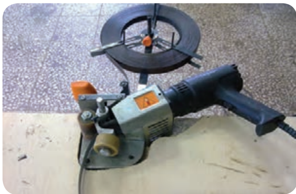
شکل ۴-۲۱ - نحوه استقرار سشوار روی میز
