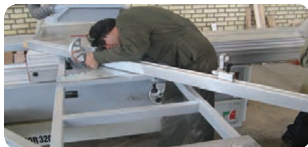
شکل ۵۰-۵- تنظیم دو کفشک کنترل اندازه گیری
