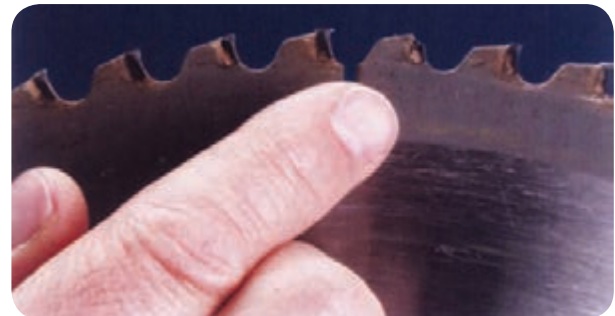
شکل ۵-۴۲- دندانه‌های اره شکسته یا کند شده
