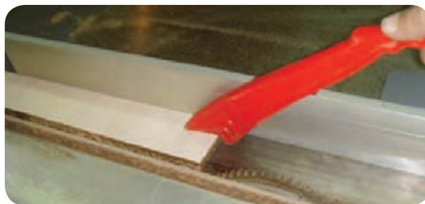
شکل ۲۷-۵- هدایت قطعه باریک در برش توسط وسیله کمکی
