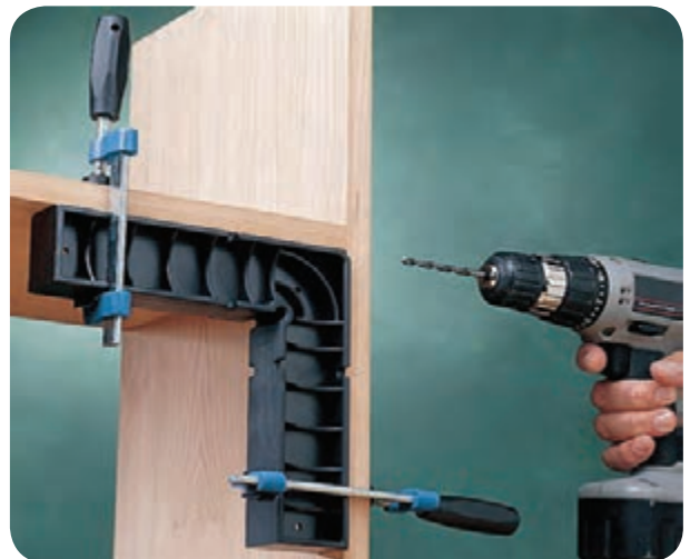
شکل ۱۷۰-۵- استفاده از شابلون برای جلوگیری از دوئیدگی
