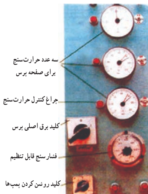
شکل ۸۷-۵- تنظیم اجزای پرس برای چسباندن روکش
