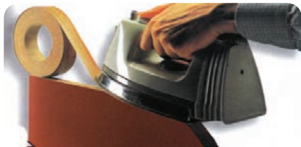
شکل ۴-۱۶ - نوار کردن لبه‌های قوس‌دار توسط اتو
