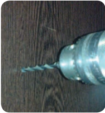
شکل ۱-۶ سوراخکاری دکور با مته چوب یا آهن
