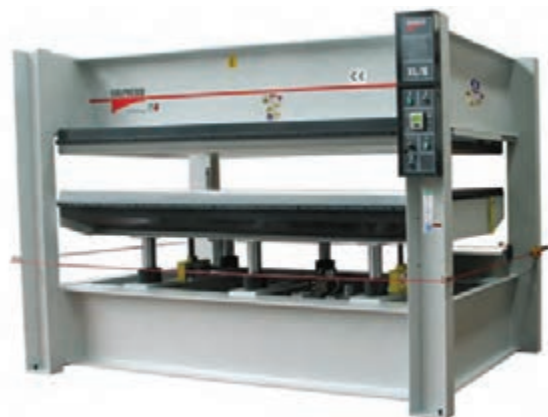
شکل ۵-۹۷- بندهای قطع اضطراری برق پرس در اطراف آن
