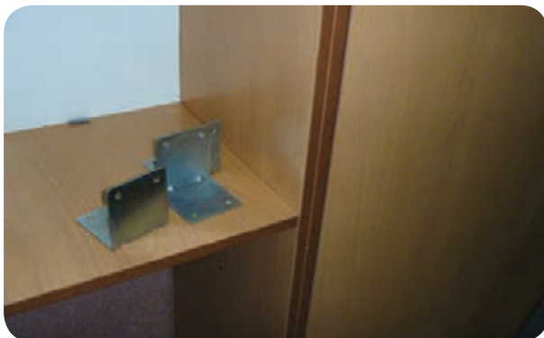
شکل ۵-۱۱۰- بدنه‌های مقر تختخواب از دو ام‌دی اف ۱۶ میلی‌متری
