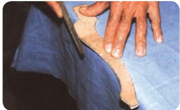
شکل ۵-۲۱- تهیه شابلن خط‌کشی برای ساخت پایه
