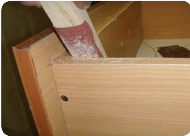
شکل ۵-۱۸۲- برطرف کردن لبه تیز صفحات با سوهان
