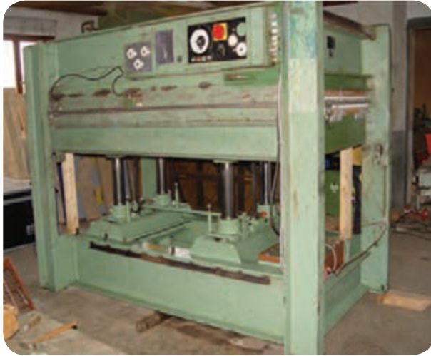
شکل ۷۴-۵ پرس گرم الممتی دو طبقه هیدرولیکی
