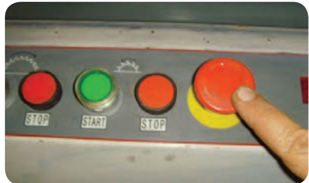
شکل ۵-۶۷- کلید خاموش کردن کلی ماشین دور کن
