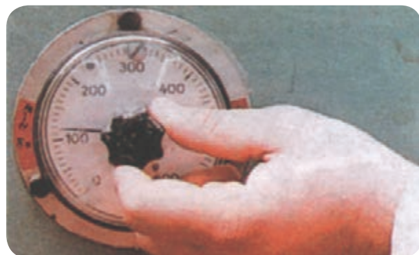
شکل ۷۹-۵ تنظیم فشارسنج پرس
