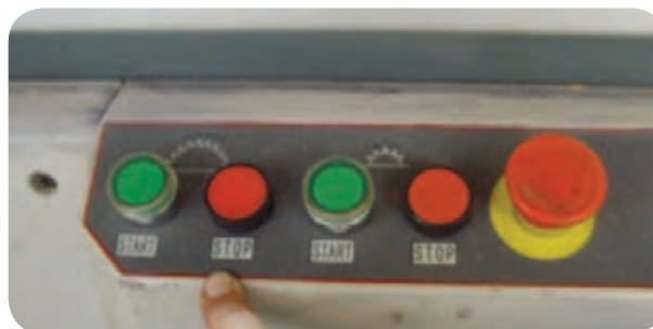
شکل ۵-۶۰- کلید خاموش و روشن کردن ماشین دورکن
