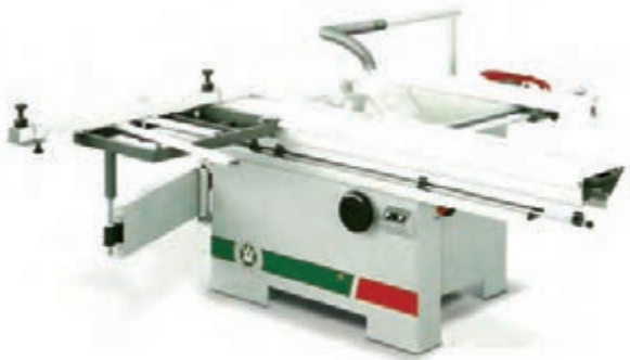
شکل ۳-۵- حفاظ طلقی قابل تنظیم اره دورکن
