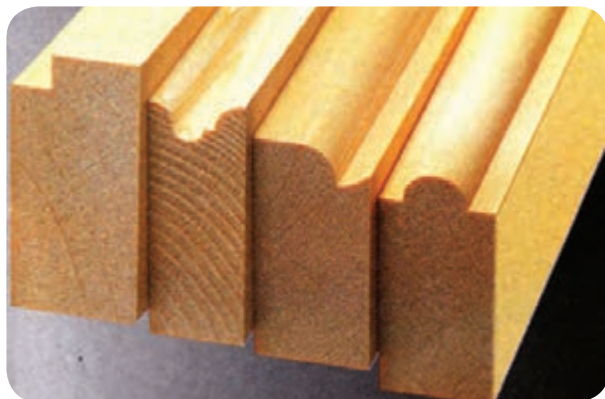
شکل ۴-۴- چند نمونه لبه‌چسبان چوبی ابزار خورده
