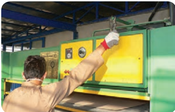
شکل ۹۵-۵- اهرم باز کردن صفحات پرس
