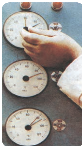
شکل ۵-۸۰- سه گیج تنظیم حرارت برای سه طبقه پرس
