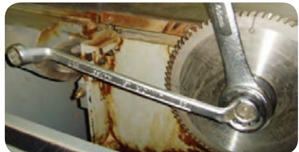
شکل ۵-۵۶- نحوه باز و بسته کردن تیغه اره
