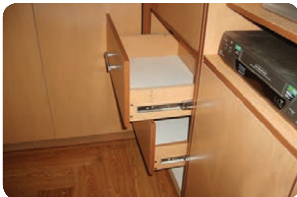
شکل ۱۷۷-۵- نصب کشویی تلسکوپی سه ريله برای کشو
