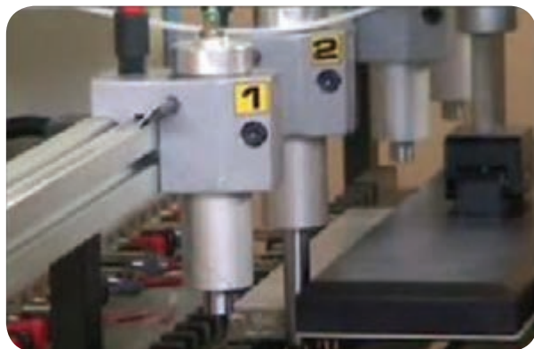
شکل ۳-۷ - قطعه کار، توسط جک‌ها گونیا شده است.
