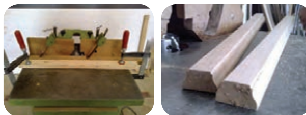
شکل ۲-۳۰- چوب ابزار خورده، ابزار زدن قطعه کار
