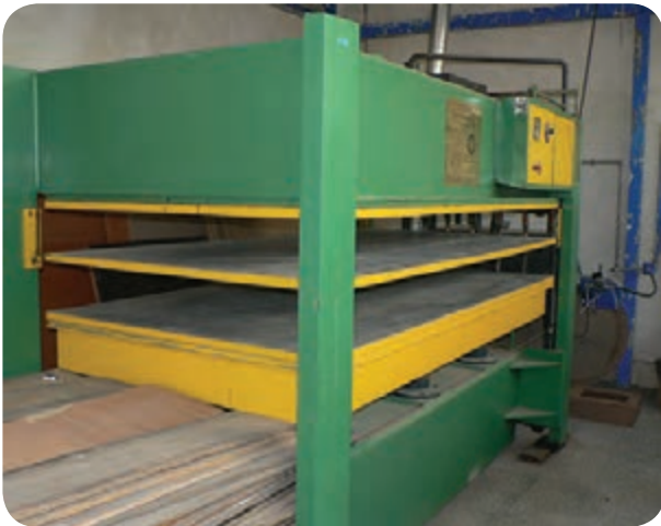
شکل ۷۵-۵ پرس سه طبقه روغنی هیدرولیک گرم
