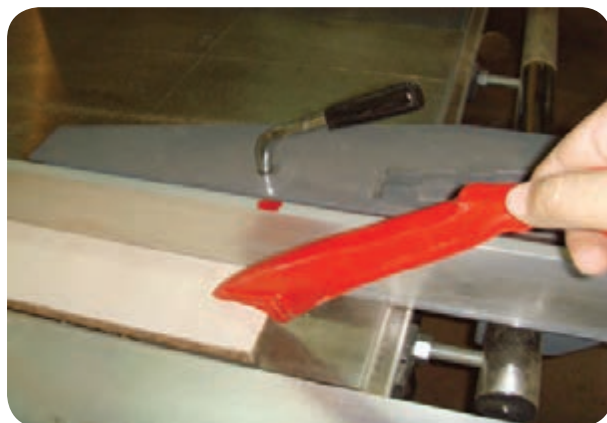
شکل ۵-۶۵- استفاده از وسیله کمکی هدایت قطعه باریک
