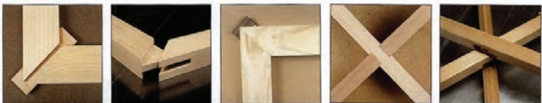
اتصال متقاطع اتصال دور و فارسی زبانۀ جدا موازی فارسی شکل (۴-۵) موارد ۱ تا ۵ اتصال دور و فارسی با زبانۀ جدا (قلیف) اتصال فاق و زبانه دور فارسی
