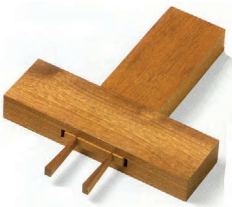
شکل (۳-۱۳۷) تصویر مجسم اتصال میانی کم و زیانه با گوه
