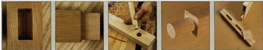
اتصال کُم و زبانه اتصال دویل سر خود اتصال دویل جدا شکل (۱-۵) موارد ۱ تا ۵ اتصال کُم و زبانه جدا
