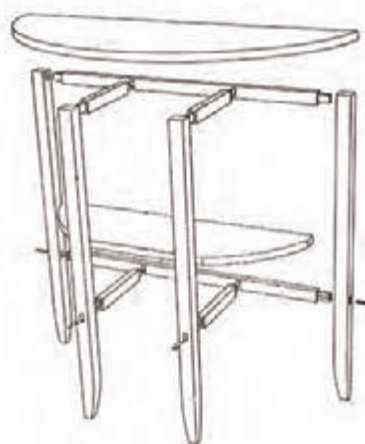
شکل (۲۵-۵) تصویر مجسم انفجاری کنسول کاربرد اتصالات گوشه‌ای و میانی کم و زبانه مخفی و باز با گوه
