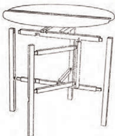
شکل (۲۴-۵) تصویر مجسم انفجاری میز با صفحه دو تکه کاربرد اتصالات گوشه‌ای کم و زبانه کوله‌دار و کم
