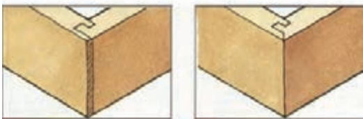
شکل (۵-۴۴) نیم و نیم دورو فارسی با دوپل اتصال قلیف زبانه سرخود
