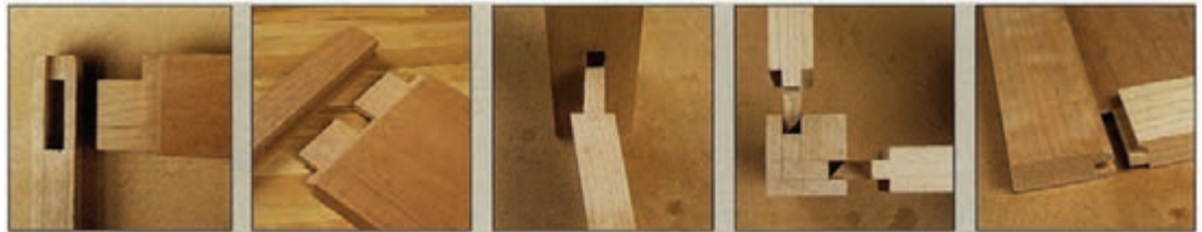
اتصال کُم و زبانه کوله دار اتصال کُم و زبانه دوزبانه اتصال کُم و زبانه کج شکل (۲-۵) موارد ۶ تا ۱۰ کُم و زبانه کوله دار قید به پایه مبلمان
