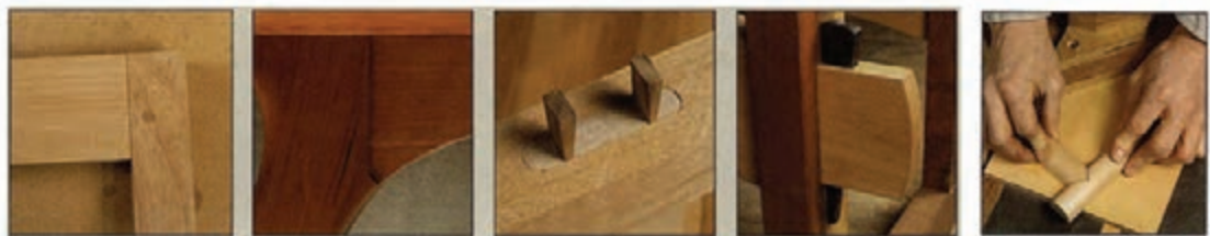
اتصال میانی آلت چینی اتصال گوه ای اتصال میانی با گوه شکل (۳-۵) موارد ۱ تا ۵ فاق و زبانه با دویل
