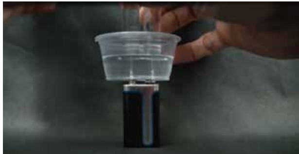
شکل ۷- الکترولیز آب، نمونه ای از کاربرد سلول‌های الکترولیتی
