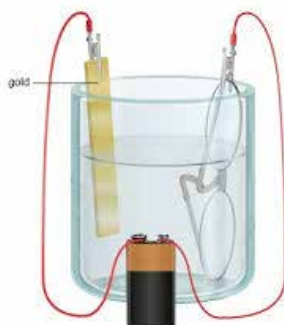
شکل ۸- آبکاری در سلولهای الکتrolیتی
