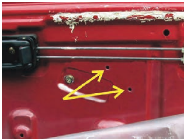
شکل ۲-۲۷ سوراخ کاری بدنه‌ی داخلی در خودرو
