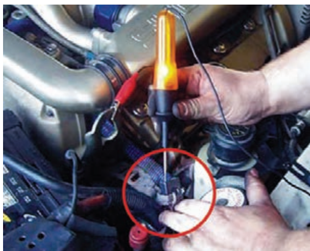
شکل ۱-۱۴۵- آزمایش برقراری جریان مدار چراغ‌های روشنایی
