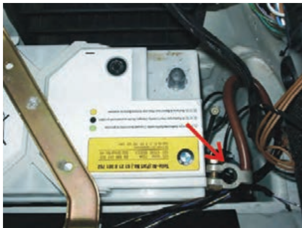
شکل ۳۵-۱- جدا کردن بست اتصال کابل بدنه‌ی باتری
