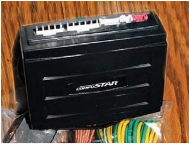
شکل ۵۷-۲- واحد اصلی سیستم دزدگیر
