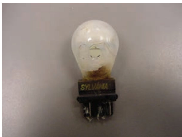
شکل ۱۴۱-۱- اثر عوامل فیزیکی در معیوب شدن لامپ
