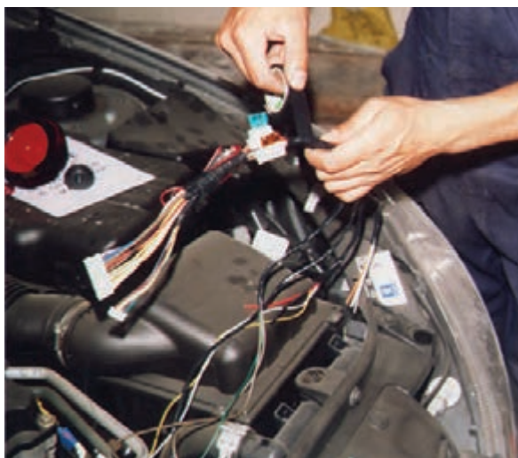
شکل ۲-۷۷- نحوه‌ی عایق‌بندی سیم‌های مدار الکتریکی دزدگیر
