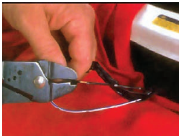
شکل ۱۴۶-۱- استفاده از انبر مخصوص برای قطع سیم
