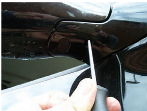
شکل ۱۷۶-۲- بازکردن پیچ روی پایه ی بیرونی آینه
