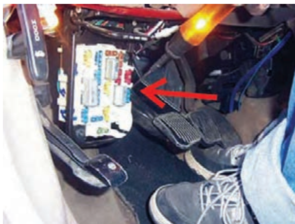
شکل ۱۲۰-۱- آزمایش جعبه‌ی فیوز با چراغ آزمایش
