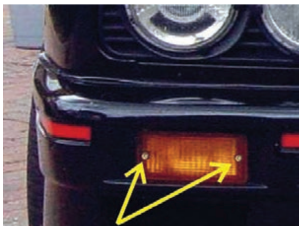
شکل ۱-۵۰- پیچ‌های اتصال تلق چراغ راهنما
