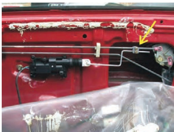
شکل ۳۱-۲- اتصال میله‌ی رابط عملگر الکتریکی به اهرم‌بندی قفل در خودرو
