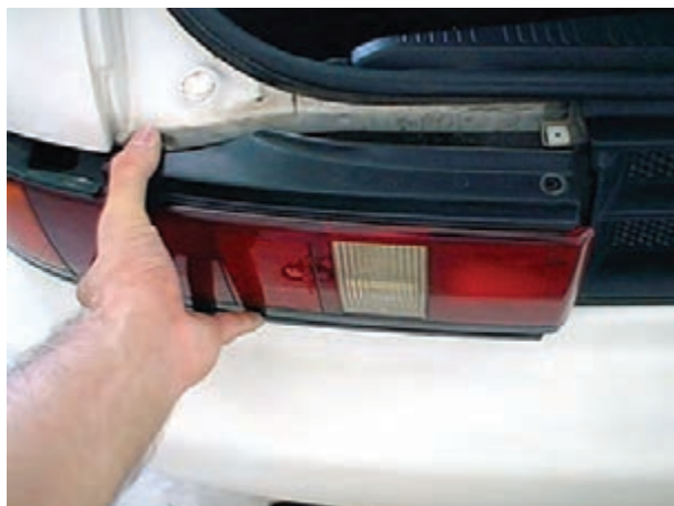
شکل ۱-۵۸- جدا کردن چراغ عقب از بدنه‌ی خودرو
