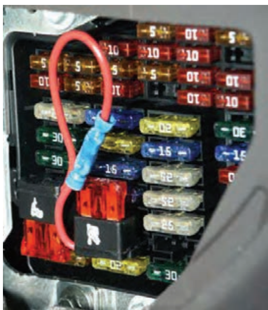
شکل ۱-۱۱۳- جعبه‌ی فیوز نصب شده در پانل جلوی راننده
