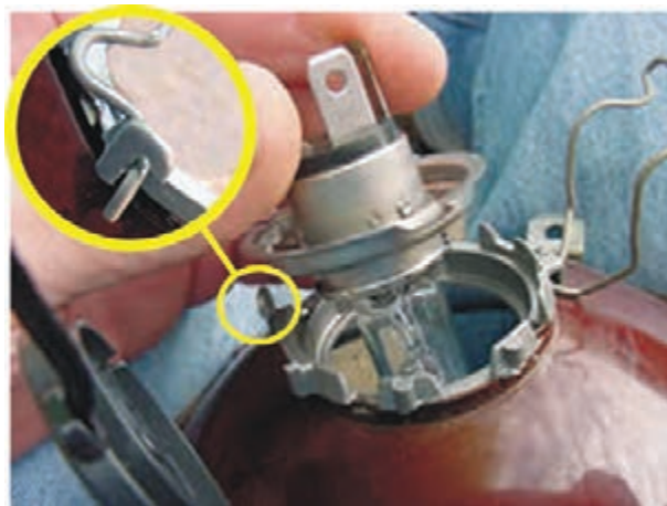
شکل ۱-۴۳- نحوه‌ی ثابت شدن لامپ درون کاسه‌ی چراغ
