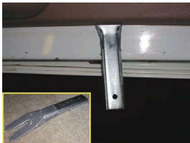
شکل ۲-۳۵- اهرم خاردرآر و نحوه‌ی استفاده از آن
