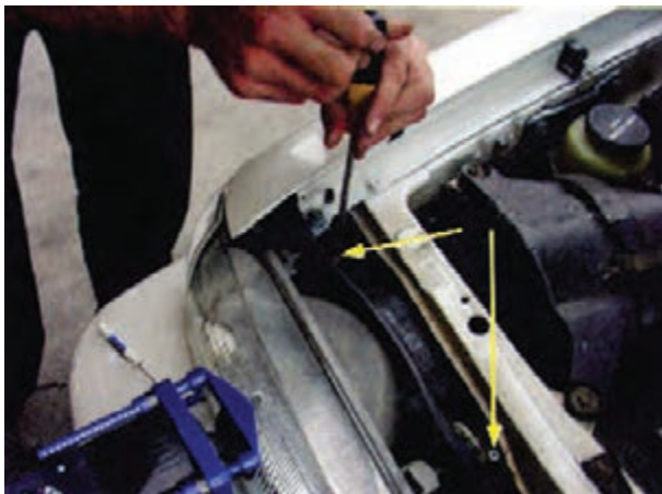
شکل ۱۶۷-۱- تنظیم‌های چراغ بزرگ جلو
