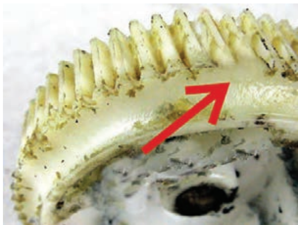
شکل ۱۲۷-۲ وجود عیب در چرخ دنده
