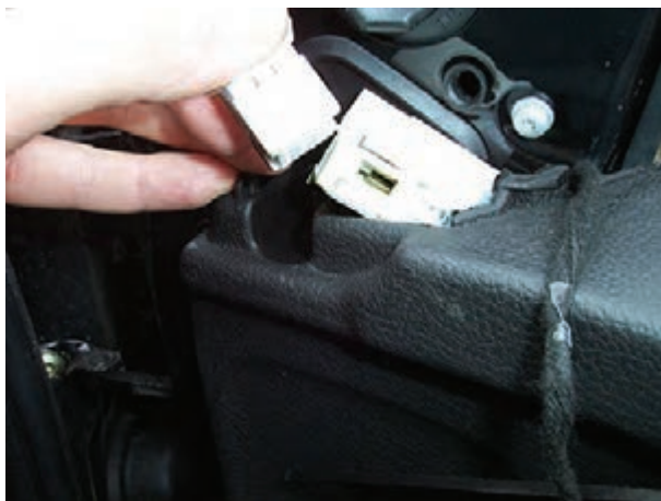
شکل ۱۶۶-۲- جدا کردن سوکت سیم کشی آینه
