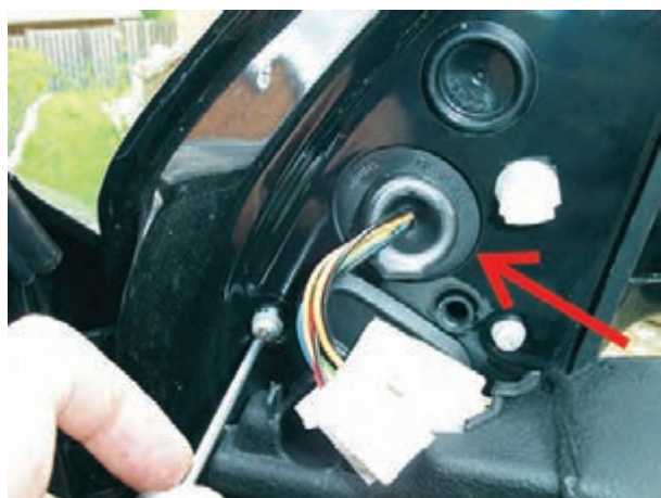
شکل ۱۷۸-۲ – باز کردن پیچ نگه‌دارنده‌ی پایه‌ی اصلی آینه
