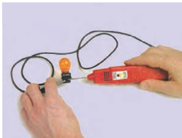
شکل ۱۸۲-۱- آزمایش لامپ چراغ راهنما
