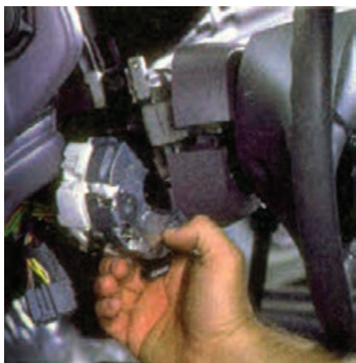
شکل ۹۶-۱- خارج کردن سوئیچ روشنایی از محل خود
