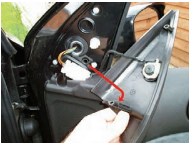
شکل ۱۶۵-۲ خارهای روی قاب و محل نصب آن
