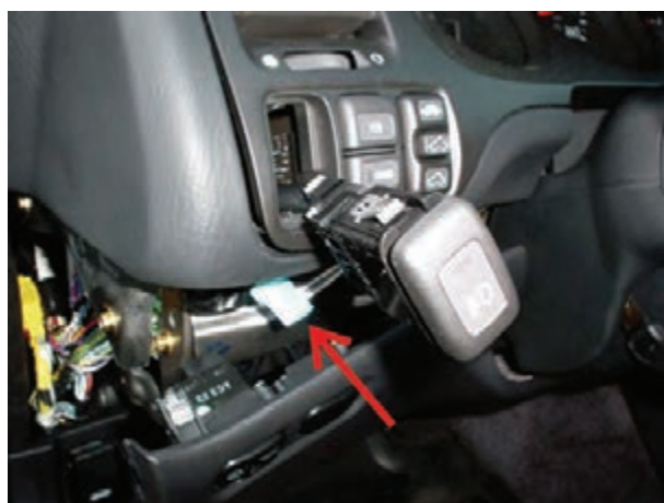
شکل ۱-۸۷- سوئیچ چراغ‌های بزرگ جلو
