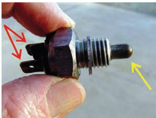
شکل ۱۰۴- پلانجر و ترمینال‌های سوئیچ دنده عقب
