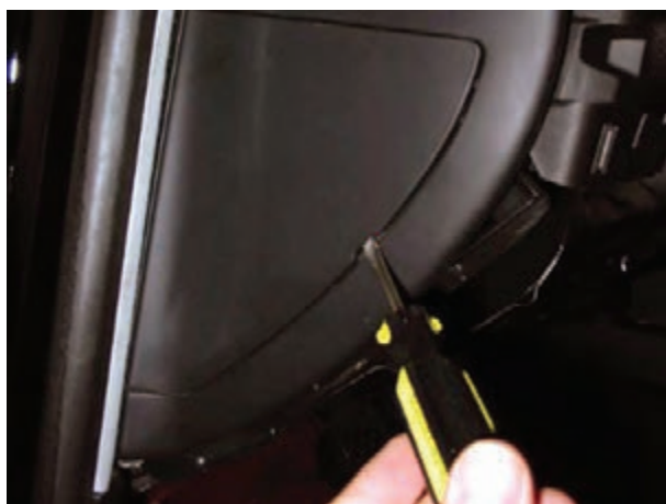
شکل ۱۱۸-۱- آزاد کردن خار پوشش محافظه‌ی جعبه‌ی فیوز
