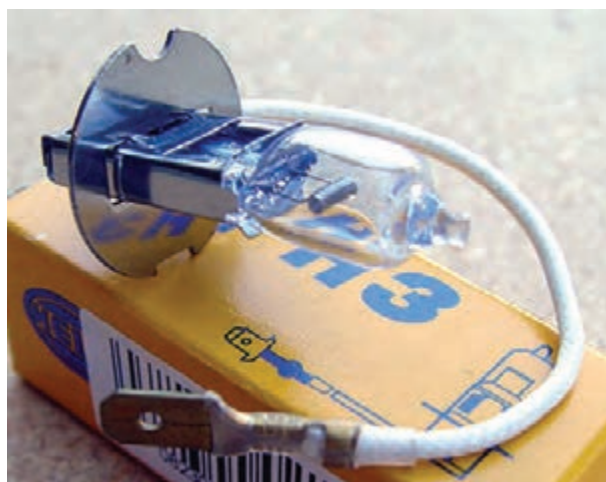
شکل ۱-۳۱- لامپ مورد استفاده در چراغ‌های مه‌شکن، نورافکن‌ها
