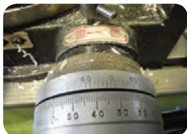
حلقه مدرج دستگیره میزگردان برای جابجایی دقیق‌تر
