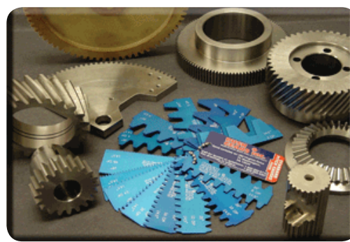
استفاده از شابلن در کنترل دنده‌ی چرخ‌دنده
