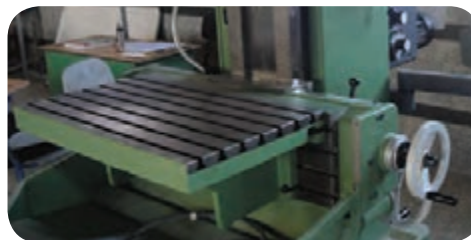
میز ماشین فرز و سیستم حرکتی آن
