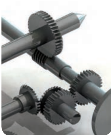
سیستم انتقال دور بین قطعه کار و صفحه سوراخ‌دار در روش اختلافی
