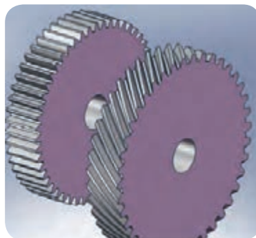
تفاوت دنده چرخ‌دنده ساده و مارپیچ
