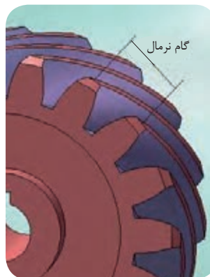
نمایشی گام نرمال در چرخ‌دنده مارپیچ
