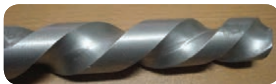
ایجاد شیار مارپیچ در یک میله گرد
