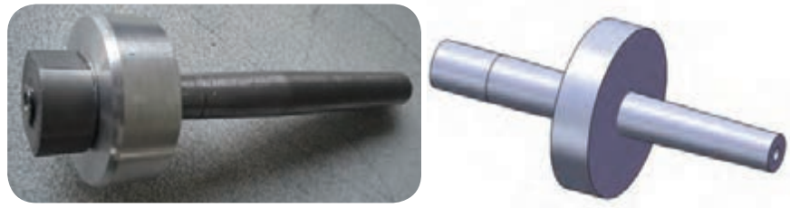
سوار کردن قطعه بر روی محور مخروطی
