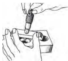
کنترل عمق سوراخ با استفاده از میکرومتر
