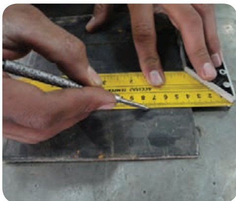
روش ترسیم خط به کمک گونبای ساده و سوزن خطکش
