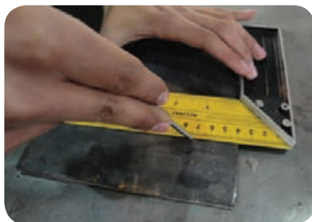
رعایت زاوایی تمایل سوزن خط‌کش
