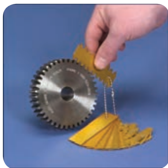
استفاده از شابلن در کنترل دنده‌ی چرخ‌دنده
