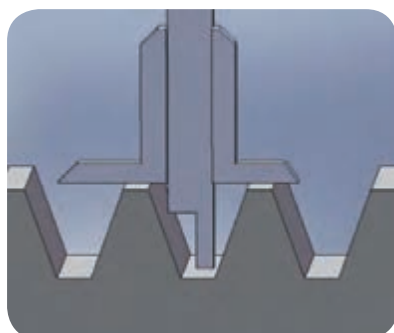
نحوه استفاده از کولیس عمق سنج
