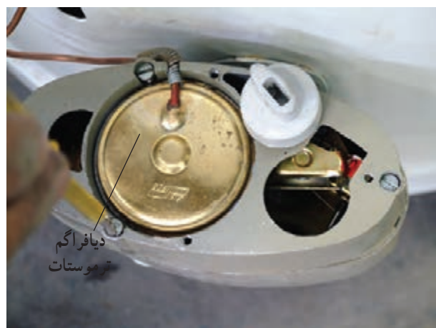
شکل ۵۵-۱-ب - دیافراگم ترموستات
