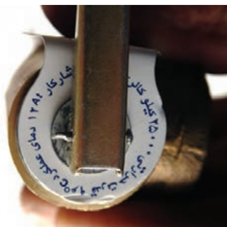
شکل ۲-۱۰۸- شیر اطمینان فشاری و حرارتی
