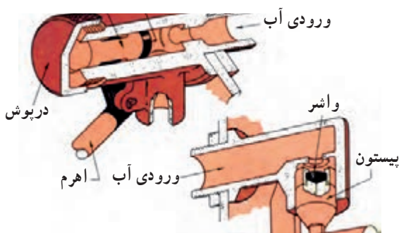
شکل ۱۱۳-۲ اجزای شیر شناور
