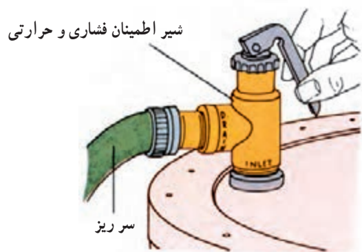
شکل ۲-۱۰۹- شیر اطمینان فشاری - حرارتی
