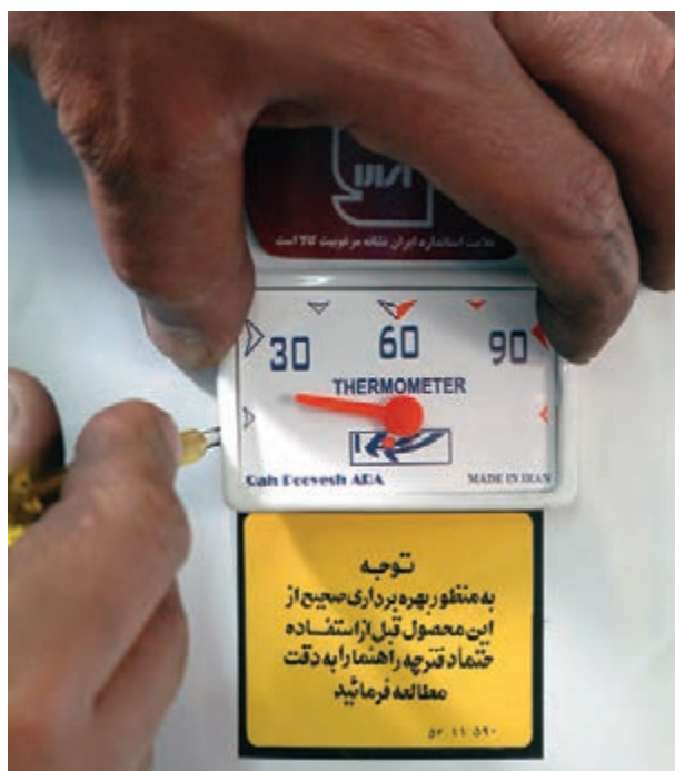
شکل ۱-۱۱۷ جدا کردن ترمومتر از روپوش
