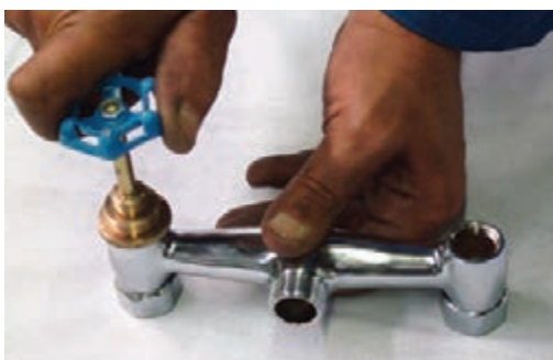
شکل ۲-۶۸- شیر تراش در حال کار شیر تراش
