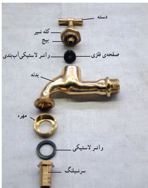
شکل ۱۲-۲- ب - اجزای شیر برنجی سرشیلنگی
