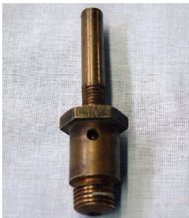
شکل ۱-۳۲- شیر قطع و وصل مخزن سوخت
