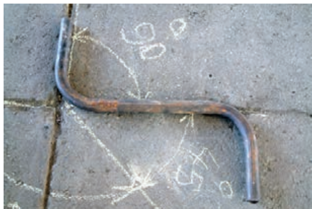
شکل ۳-۴۱- عدم دویدگی لوله‌ی دو خم
