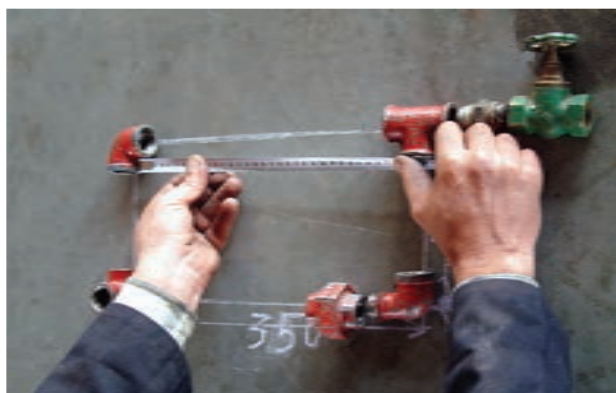
شکل ۵-۱۱۲- اندازه‌گیری طول لوله
