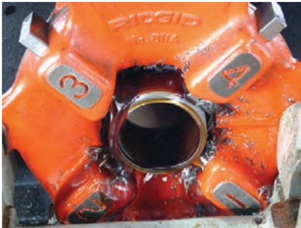
شکل ۸۲-۴- استفاده از روغن در موقع حدیده‌کاری
