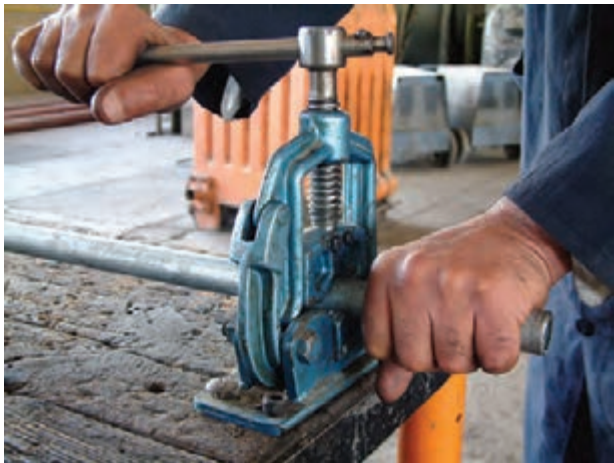
شکل ۱-۳۵ - بستن لوله به گیره برای ارّه کاری
