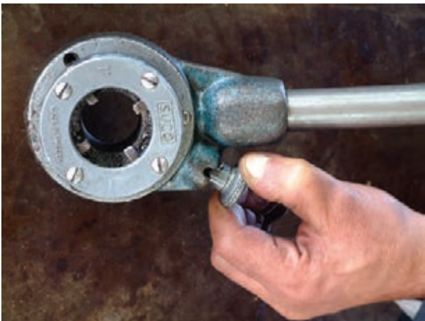
شکل ۴-۴۳- خارج کردن ضامن از شیار
