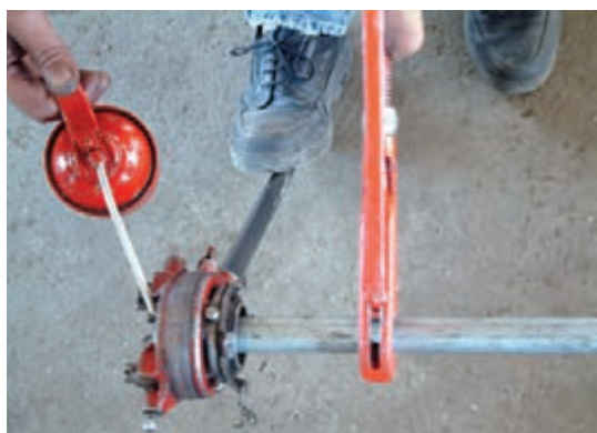
شکل ۱۲۱-۵- استفاده از روغن در جریان حدیده کاری
