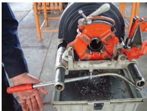
شکل ۴-۹۸- کشیدن اهرم به عقب پس از حدیده‌کاری
