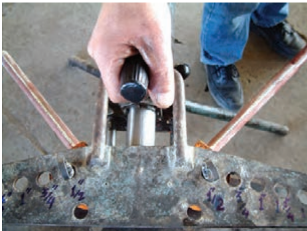
شکل ۱۲-۳- بعد از عمل خم کاری
