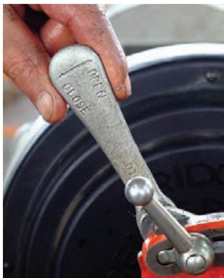
شکل ۴-۹۷- کشیدن ضامن تنظیم به عقب
