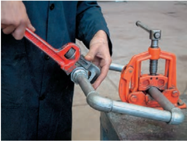
شکل ۱۰۶-۵- نحوه‌ی غلط سفت کردن مهره ماسوره
