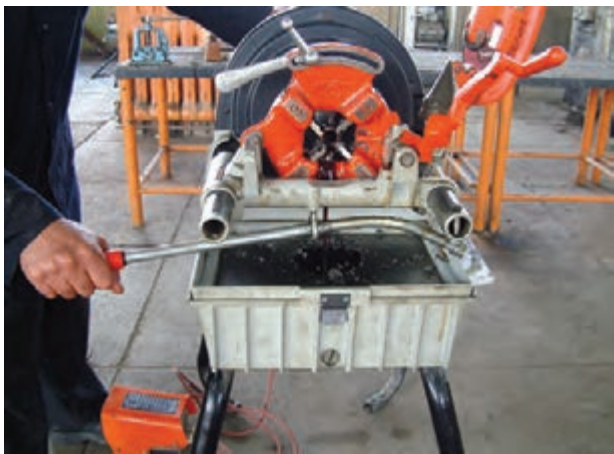
شکل ۱۳۳-۴- عمل حدیده کاری لوله
