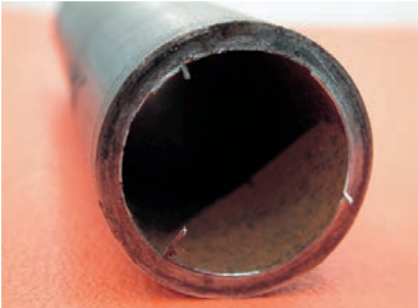
الف - لوله‌ی بریده شده به وسیله‌ی لوله‌بر
