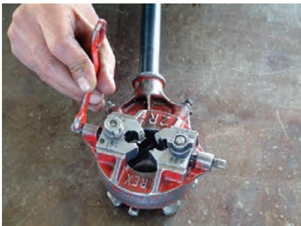
شکل ۴-۲۹- تنظیم کردن حدیده به وسیله‌ی آچار حدیده
