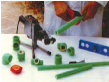
شکل ۲۷-۵- بریدن لوله به وسیله‌ی قیچی مخصوص
