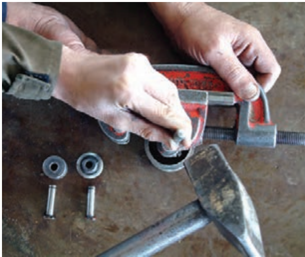
شکل ۱-۱۹- خارج کردن پین‌ها به وسیله‌ی سنبه‌نشان و چکش فلزی
