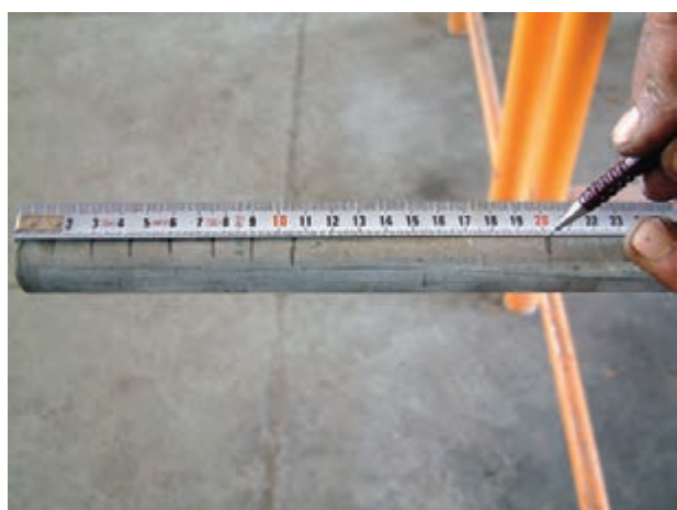
شکل ۱-۶۴- خطکشی کردن لوله
