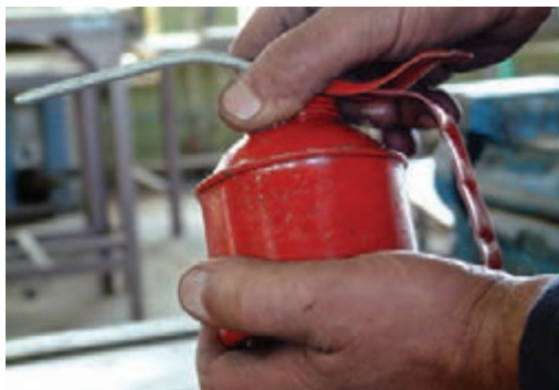
الف - باز کردن پمپ از مخزن روغن
