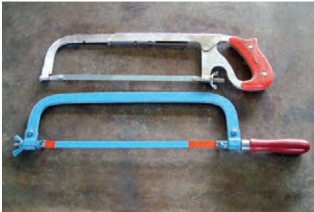
شکل ۱-۵- کمان ازّه‌ی ثابت با دسته‌ی معمولی و متغیّر با دسته‌ی هفت تیری
