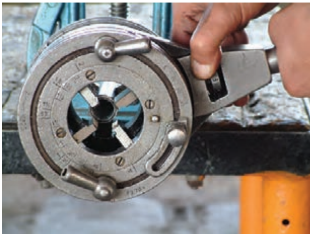
شکل ۴-۶۵- خارج کردن ضامن جهت چرخش در جهت R
