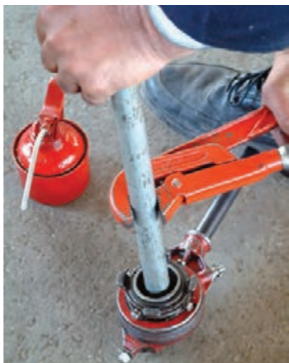
شکل ۱۱۹-۵- گرداندن لوله به وسیله‌ی آچار لوله‌گیر دو دسته در جهت حدیده شدن لوله
