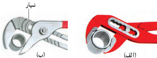
شکل ۵-۷۰- سوراخ‌ها و شیارهای متعدد آچارهای کلاغی
