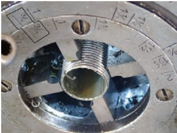
شکل ۴-۶۹- حد صحیح حدیده کردن لولهی ۳/۴"
