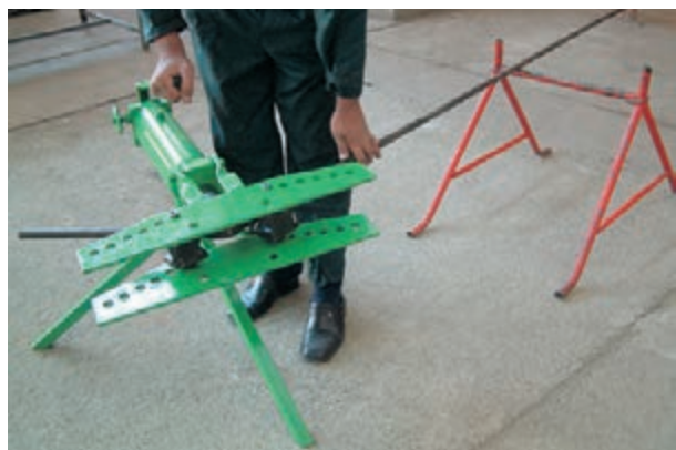
شکل ۳-۴۲- استفاده از خرک در خم کاری
