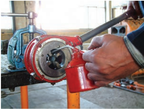
شکل ۱۲۳-۴- استفاده از روغن دان در جریان حديدكاري
