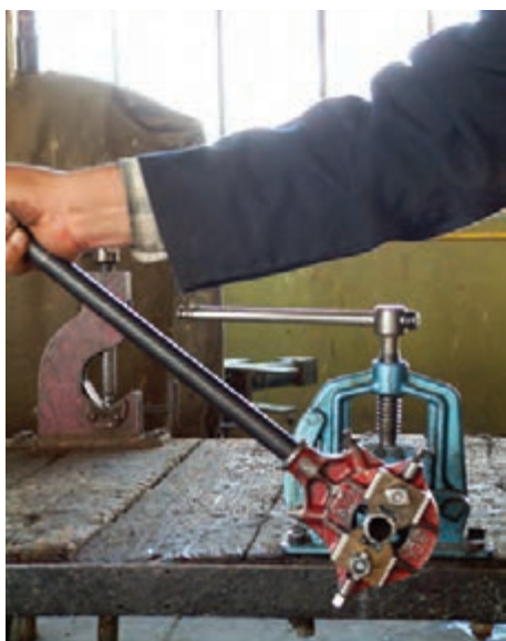
شکل ۴-۳۸- گرداندن دسته‌ی حدیده در جهت خلاف حرکت عقربه‌های ساعت
