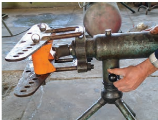
شکل ۲۱-۳- قرار دادن پارچه‌ی خم‌کن در محل خود و سفت کردن پیچ ثابت‌کننده‌ی خم‌کن بر روی سه‌پایه
