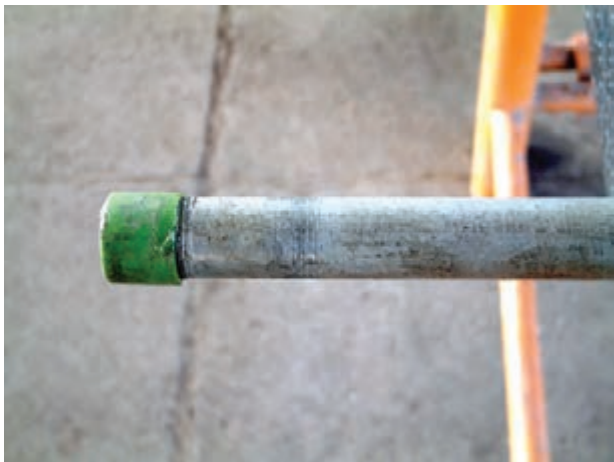
شکل ۱۶-۴- اتصال بوشن پلاستیکی به سردنده‌ی لوله
