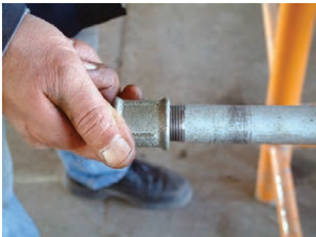
شکل ۴-۴۱- کنترل بار سردنده به وسیله‌ی یک فیتینگ
