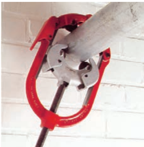
شکل ۱-۲۳- لوله‌بر دستی چهار تیغه
