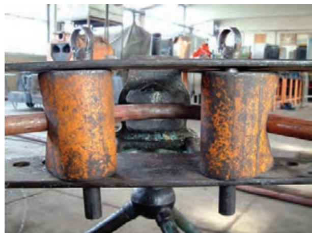
الف- باز کردن خم لوله‌ی خم شده
