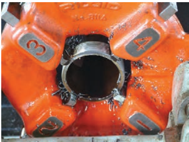
شکل ۴-۸۰- لوله در حال باز شدن از پارچه ها
