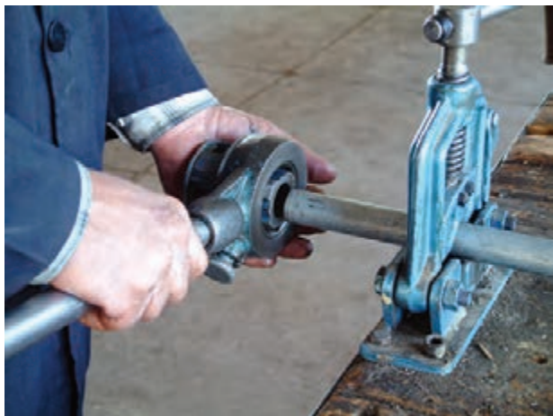
شکل ۴-۴۵- شروع حدیده کاری
