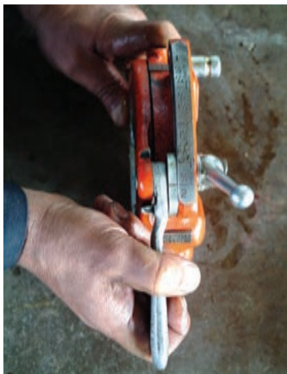
شکل ۴-۹۳- تنظیم حدیده به اندازه‌ی لوله‌ی ۲ اینچ
