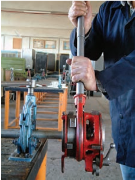
شکل ۱۲۶-۴- باز کردن حدیده از لوله
