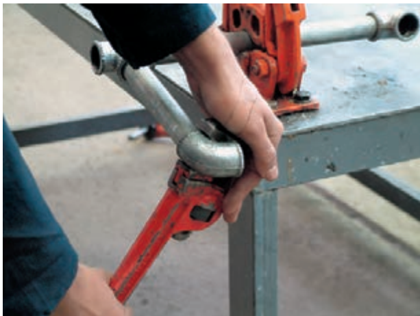
شکل ۱۰۵-۵- روش غلط سفت کردن مدار
