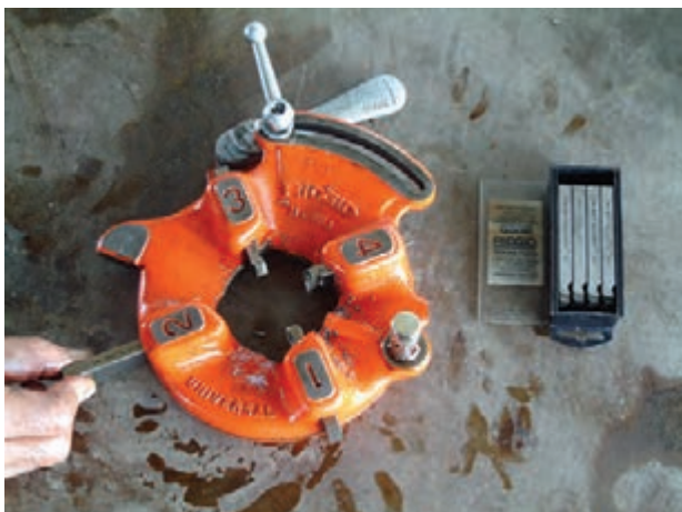
شکل ۴-۹۲ جا زدن پارچه‌ها در شیارهای تنه‌ی حديد
