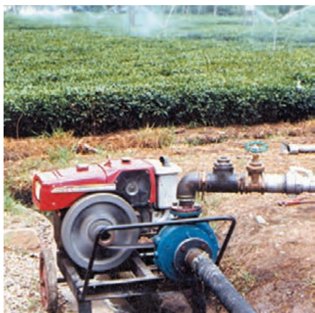
شکل ۴-۶- آبیاری بارانی با سیستم ثابت
