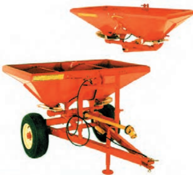
شکل ۲-۲- بذریاش سانتریفوژ با چرخهای ثابت (کششی)
