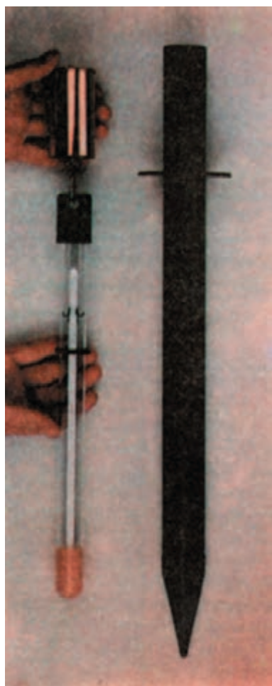
شکل ۲-۲- دماسنج برای اندازه‌گیری درجه حرارت خاک
