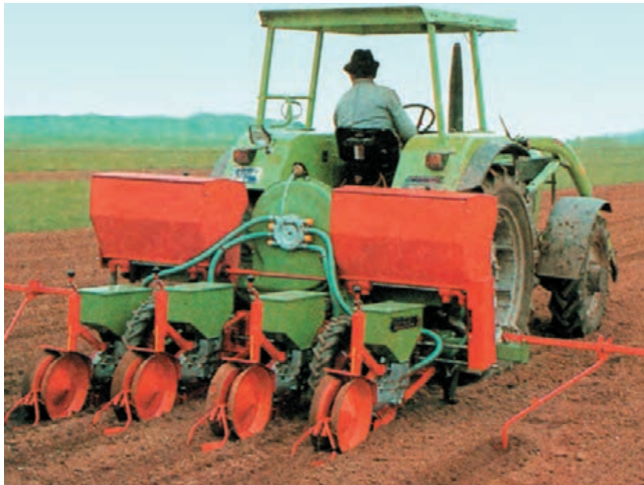
شکل ۲-۴- یک ردیفکار پنوماتیکی حین انجام کار
