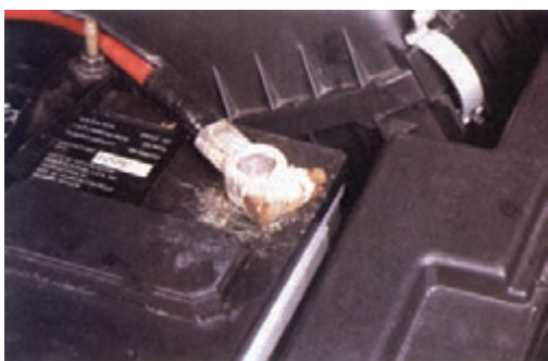
شکل (۲-۸۱) سولفاته شدن بست باتری
