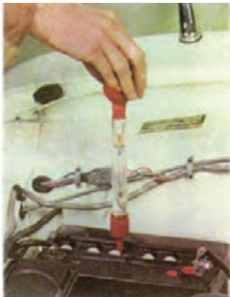
شکل (۲-۸۸) اندازه گیری غلظت مایع باتری
