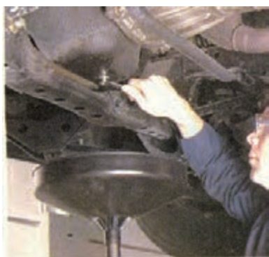
شکل (۲-۵۷) بستن پیچ تخلیه با گشتاور مناسب
