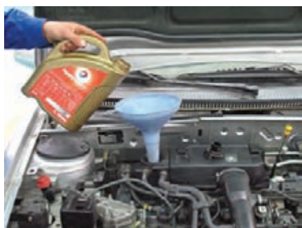
شکل (۲-۵۸) شارژ با روغن توصیه شده
