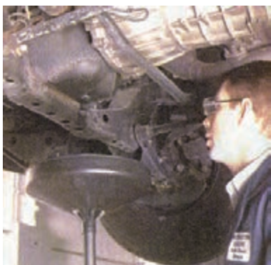
شکل (۲-۵۵) کنترل تخلیه شدن کامل روغن
