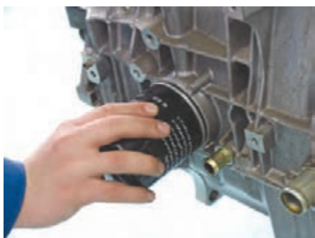
شکل (۲-۵۴) نصب و محکم کردن فیلتر
