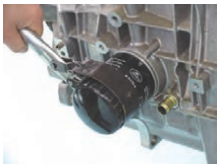
شکل (۴۸- ۲) بازکردن فیلتر با ابزار مخصوص
