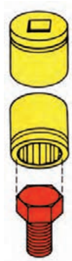
شکل (۱-۱۷) نحوه درگیری آچار بوکس
