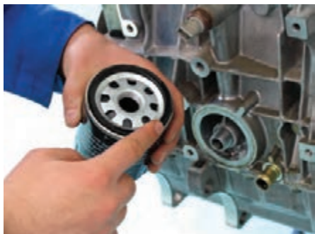
شکل (۲-۵۳) کنترل دندانه و واشر لاستیکی فیلتر
