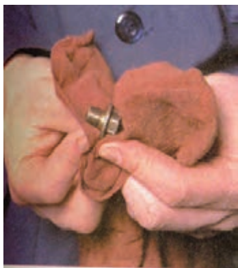
شکل (۲-۵۶) کنترل پیچ تخلیه ی روغن موتور
