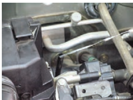
شکل (۲-۵۹) کنترل روغن
