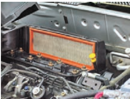
شکل (۲-۶۲) فیلتر سیستم هوارسانی
