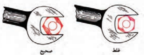
شکل (۱-۳) استفاده‌ی اصولی از ابزار
