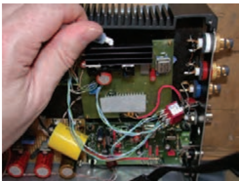
شکل ۷-۱۴ محل نصب هیت سینک
