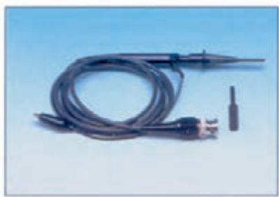
شکل ۸۵-۱ کاربرد کابل کواکسیال در برابر اسیلوسکوپ
