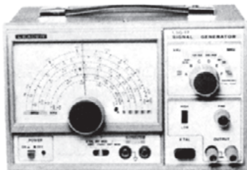
شکل ۱-۱۳۶ الف - سیگنال ژنراتور RF
