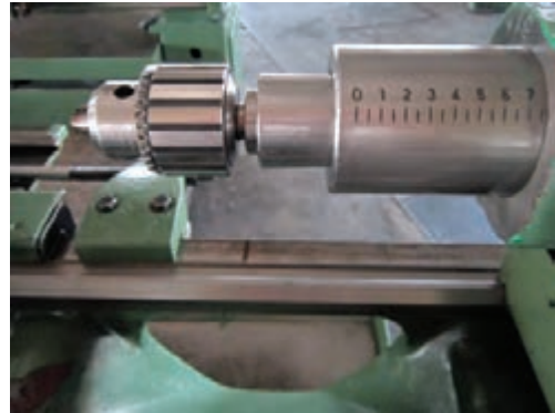
روتراشی - پله تراشی
