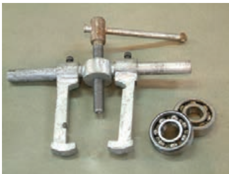
شکل ۴۷-۱- بلبرینگ‌ها پس از جدا شدن از محور
