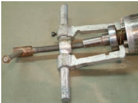
شکل ۴۶-۱- استقرار بلبرینگ کش‌روی محور روتور
