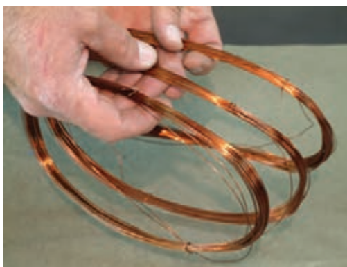
شکل ۱۹-۳ درآوردن کلاف از قالب
