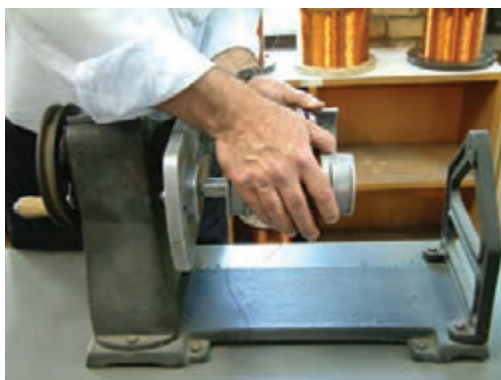
شکل ۱۸-۳ باز کردن قالب‌ها
