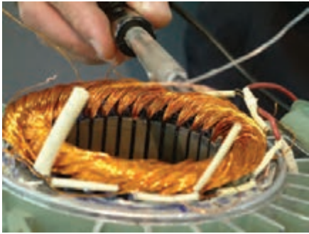
شکل ۴-۷- لحیم کاری محل اتصال سیم ها
