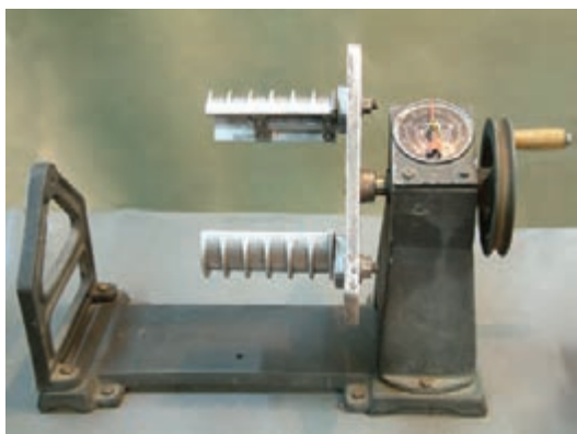
شکل ۱۵-۳- تنظیم اندازه‌ی قالب‌ها در کلاف پیچ
