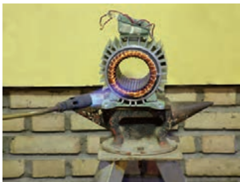
شکل ۲-۱۸- سوزاندن مستقیم سیم‌ها با شعله
