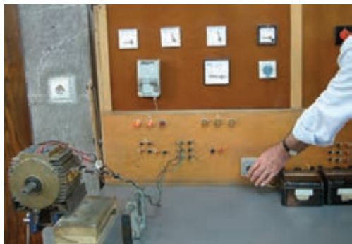
شکل ۹-۶- اتصال موتور به تابلوی برق
