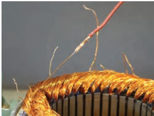
شکل ۴-۱۱- اتصال سیم‌های افشان به سیم‌های لاک‌ی
