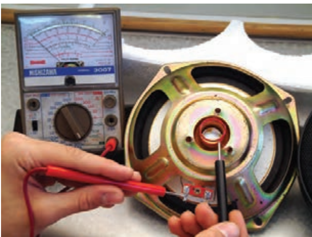
شکل ۳۹-۱ اندازه‌گیری مقاومت بلندگو
