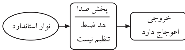
شکل ۱۰-۵- پخش سیگنال توسط دستگاهی که هد آن تنظیم نیست.
