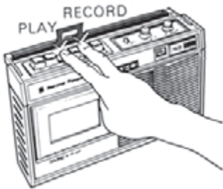
شکل ۳-۴۳- فشردن همزمان کلیدهای فشاری پخش (Play) و ضبط (Record)
