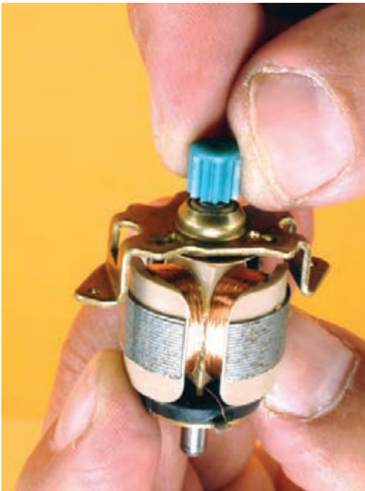
شکل ۱-۲۳- انواع موتورهای اونیورسال بکار برده شده در دستگاه‌های الکتریکی
