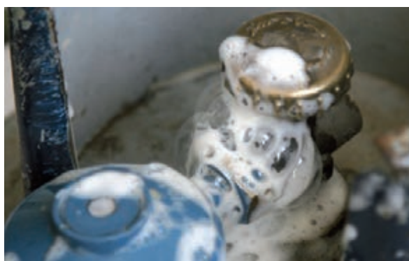
شکل ۱-۶۷ پ آزمایش گازبندی محل اتصال رگولاتور به کپسول و شیلنگ
