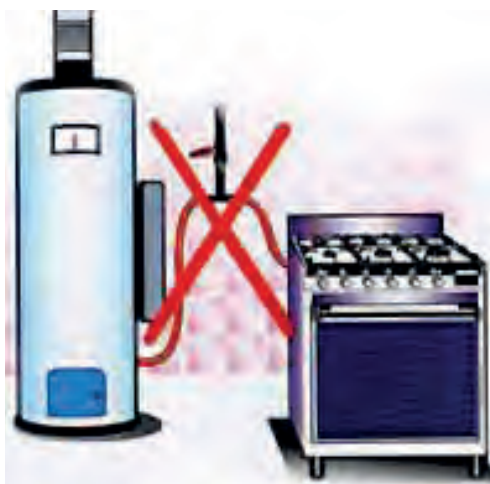
شکل ۳-۹ نصب نادرست آب‌گرم‌کن زمینی به جای
