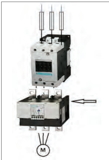
شکل ۳۹- رله اضافه بار شینه دار
