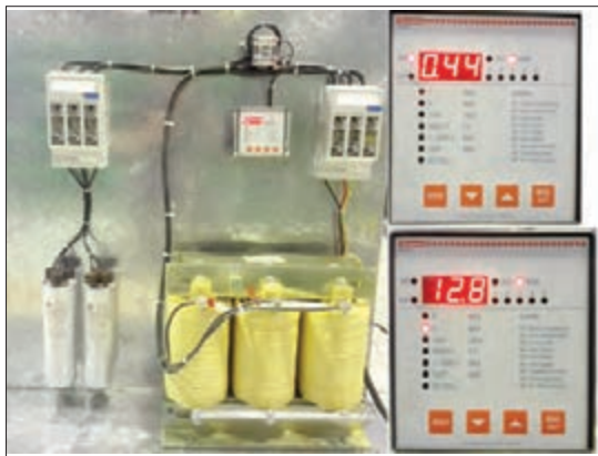
شکل ۱۷- میزان جریان و ضریب توان بار با اتصال خازن
