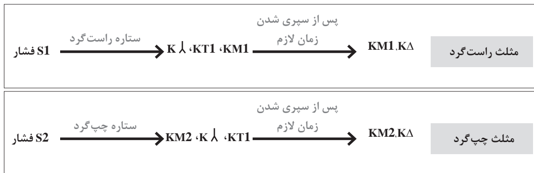
شکل ۲۶- نحوه عملکرد قطعات در مدار فرمان
