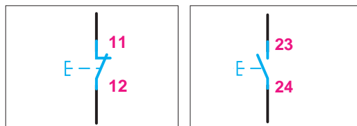
الف) ترمینال با تیغه بسته (ب) ترمینال با تیغه باز
