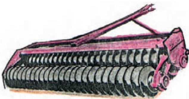
شکل ۴-۵- غلتک پره‌ای دو ردیفه
