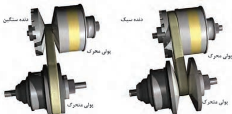
شکل ۶۲- نحوه عملکرد پولی‌های با قطر متغیر
