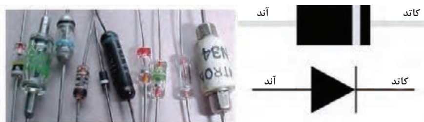
شکل ۹- برخی از انواع دیود
