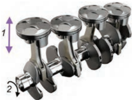
شکل ۱۹- کاربرد مکانیزم لنگ و لغزنده در موتور
