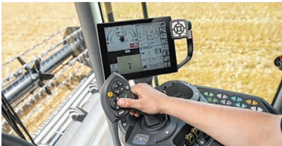
شکل ۱۵- نمونه‌ای از سامانه نظارت بر عملکرد کمباین
