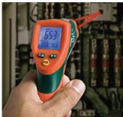
شکل ۲۲- حسگر حرارتی غیر تماسی
