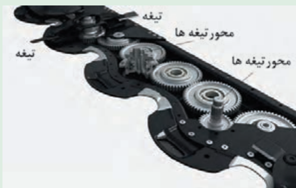
شکل ۵۱ - چرخ دنده‌های محرک تیغه‌ها در دروگر بشقابی
