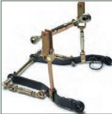
شکل ۶- میله‌ها و مفصل‌های اتصال سه نقطه تراکتور
