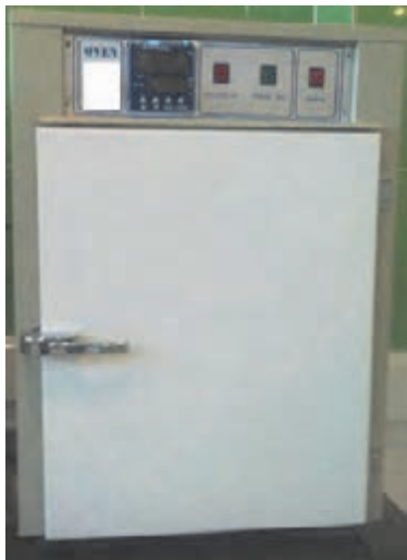
شکل ۵ ▲ دستگاه گرم‌چال (Oven)
