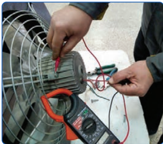
شکل ۲۰- اندازه گیری مقاومت اهمی موتور یونیت هیتر
