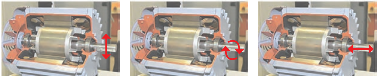
شکل ۱۸- کنترل ظاهری بلبرینگ موتور یونیت هیتر
