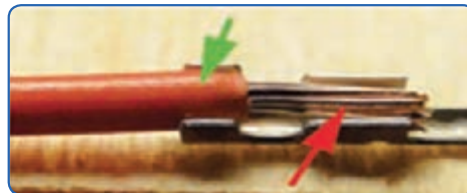
شکل ۱۱- جازدن سر سیم در سیم افشان
