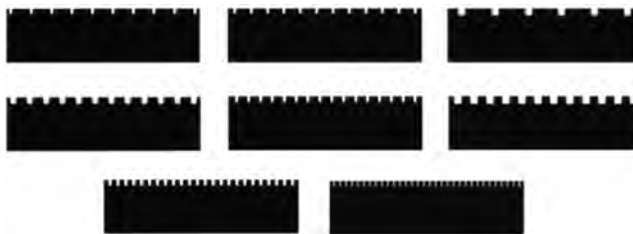
شکل ۸۱- چند نمونه تیغ پرفراژ
