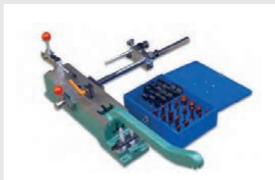
شکل ۱۰۳- دستگاه خم کن دستی
