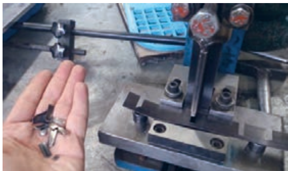
شکل ۹۶- دستگاه جداکننده پل روی تیغ
