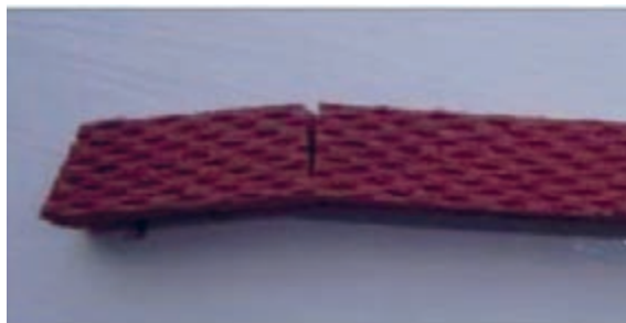
شکل ۱۴۷- لاستیک با درجه شور نامناسب
