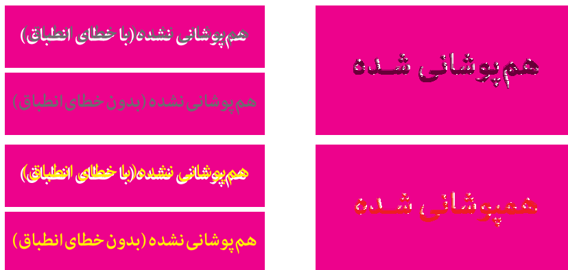
شکل ۵۳- تفاوت رنگ حالت هم پوشانی شده و حالت عادی
