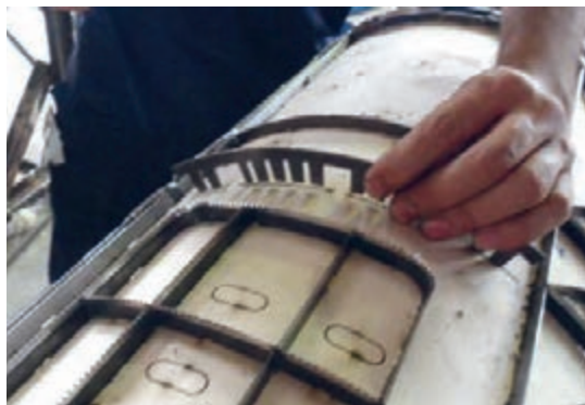
شکل ۱۳۳- قرار دادن تیغ‌ها در سیلندر
