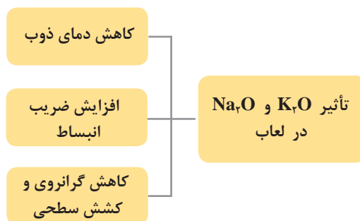
نمودار ۴- تأثیر سدیم اکسید و پتاسیم اکسید در لعاب
