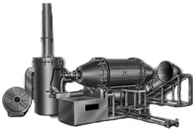
شکل ۲۰- مجموعهٔ کورهٔ دوّار ناپیوسته
