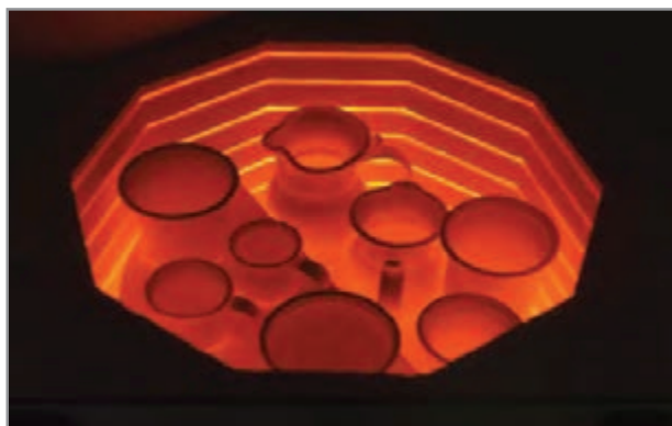
شکل ۲- بدنه‌های سرامیکی در حال پخت
