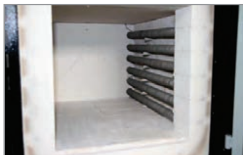
شكل ۱۲- نصب المنت بر روی پایه
