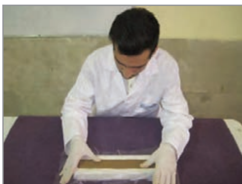
شکل ۳۲- ساخت نمونه‌های مقاومت به پخت
