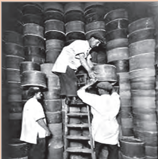
شکل ۶۷ - چیدمان ستونی ساگارها در کوره‌های سنتی
