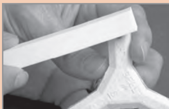
شکل ۵۹ - تمیز کردن نوک پین‌ها
