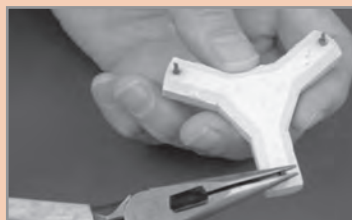
شکل ۵۸ - تعویض پین‌های فلزی
