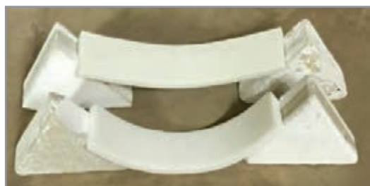
شکل ۳۰- آزمایش مقاومت پخت دو تکیه‌گاهی
