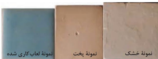
شکل ۱۲- تأثیر انقباض پخت بر ابعاد نمونه
