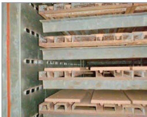
شکل ۱۶- دمش هوا از روزنه ها به قطعه
