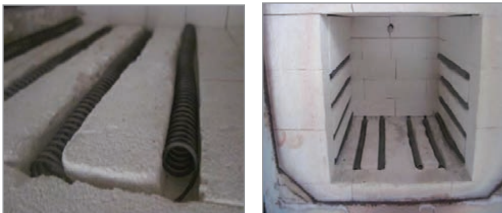
شکل ۱۳- نصب المنت درون شیار
