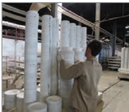
شکل ۴۹- استفاده از ساگار برای چیدمان
