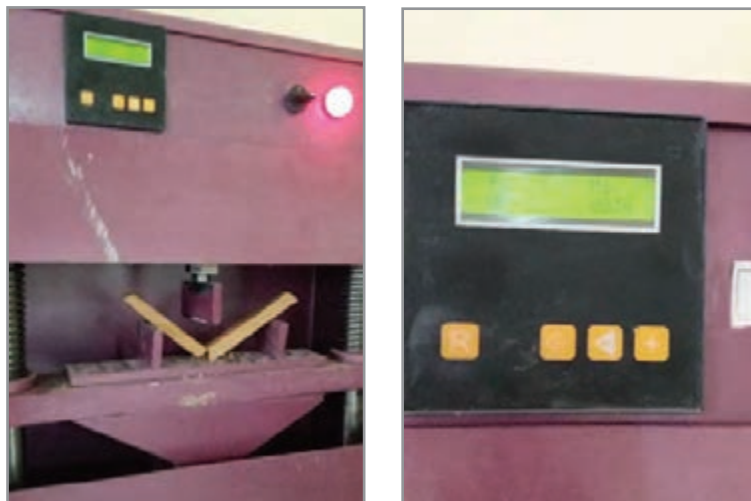
شکل ۲۴- اندازه‌گیری استحکام خمشی خشک نمونه‌ها
