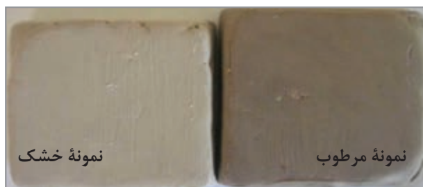
شکل ۲- تأثیر انقباض خشک در کاهش ابعاد نمونه
