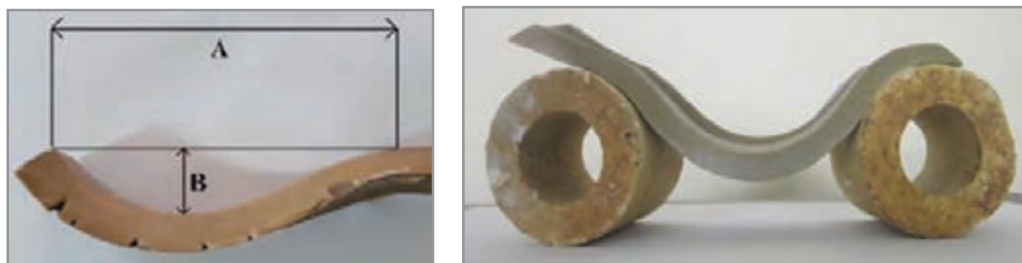
شکل ۳۶- اندازه‌گیری میزان انحنای نمونه مقاومت به پخت
