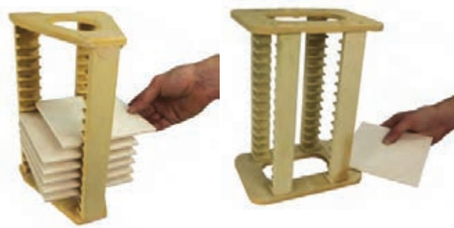
شکل ۵۱ - چیدمان کاشی در چنگک
