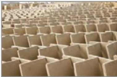
شکل ۱۰- خشک شدن قطعات در گرمای آفتاب
