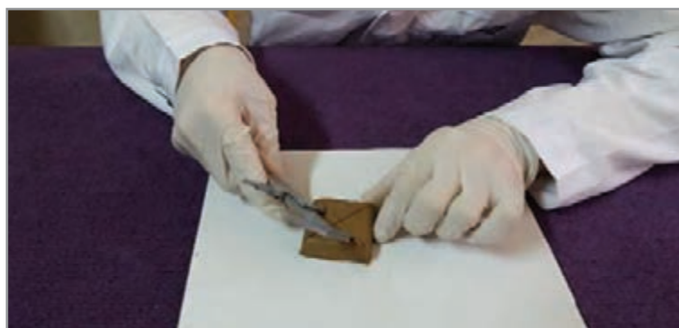
شکل ۸- علامت‌گذاری به وسیله کولیس
