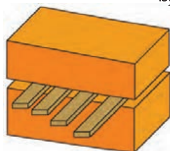
شکل ۲۹- آزمایش مقاومت پخت یک تکیه‌گاهی
