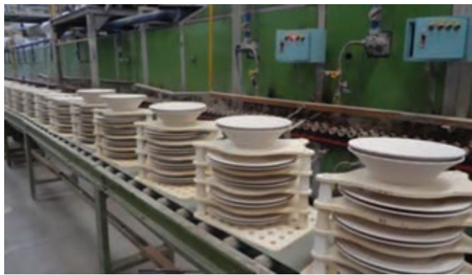
شکل ۴۲- استفاده از سترها برای پخت ظروف
