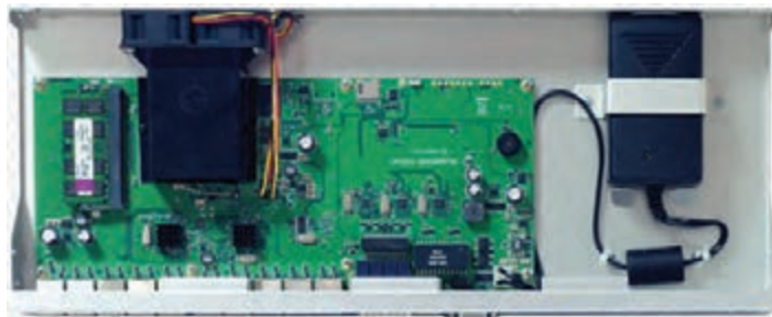
شکل ۴- نمای داخلی مسیریاب میکروتیک
