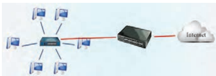
شکل ۲۳- محل قرارگیری فایروال بین شبکه داخلی و شبکه خارجی
