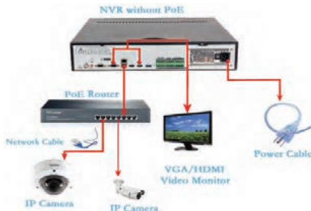
شکل ۱۷- اتصال دوربین به NVR
