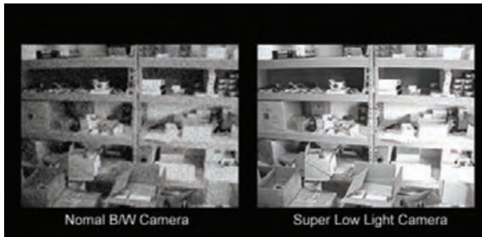
شکل ۱۸- تأثیر مشخصه Minimum Illumination در تصویر
