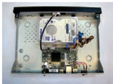
شکل ۲۱- دستگاه باز شده NVR
