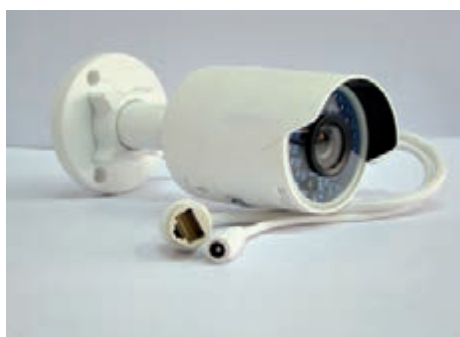
شکل ۱- اجزای دوربین تحت شبکه
