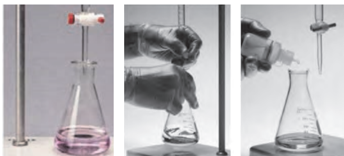
شکل ۱۲- شیوه سنجش حجمی محلول سرکه با سدیم هیدروکسید استاندارد
