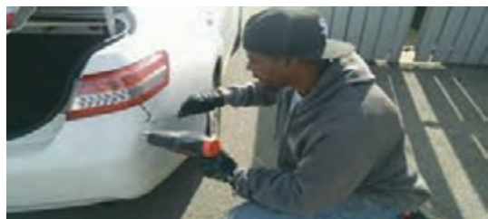
شکل ۲۲- جوشکاری تعمیری قطعات پلاستیکی
