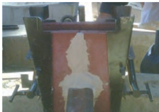
شکل ۱۹- آب‌بندی قالب با استفاده از گل مخصوص
