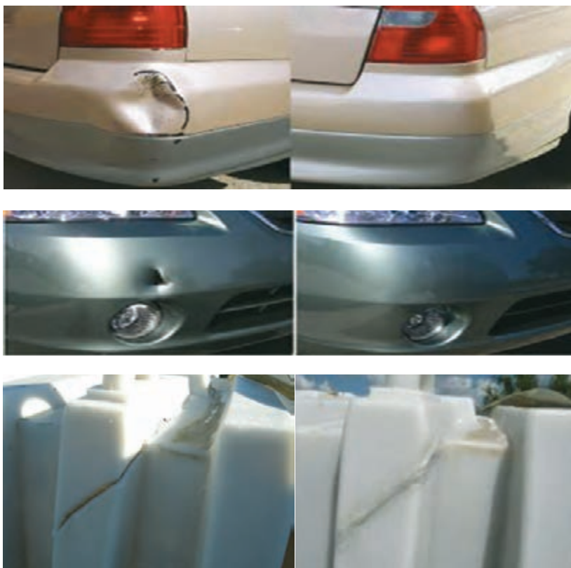
شکل ۲۳- نمونه‌هایی از جوش تعمیری قبل و بعد از جوشکاری
