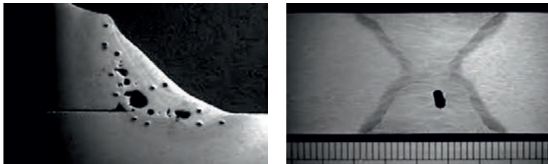
شکل ۳۱- مک و تخلخل در جوشکاری قطعات پلاستیکی
