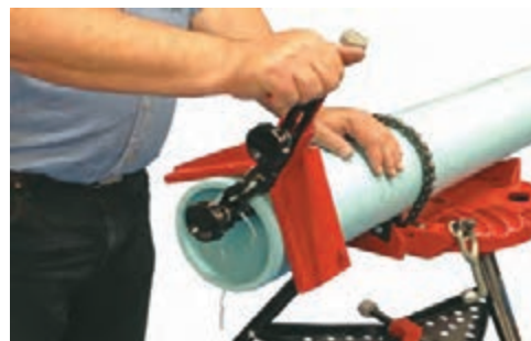
شکل ۲۴- پخ زدن قطعات پلاستیکی برای جوشکاری
