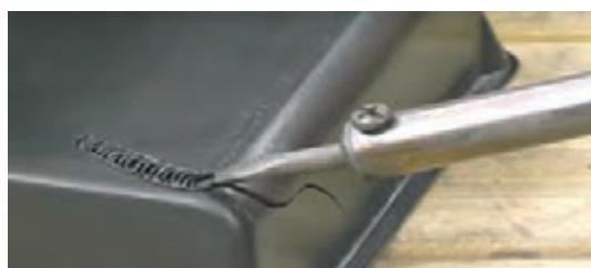
شکل ۲۲- جوشکاری تعمیری قطعات پلاستیکی
