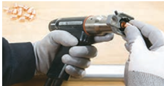
شکل ۱۹- قرار دادن گل میخ در داخل نگهدارنده
