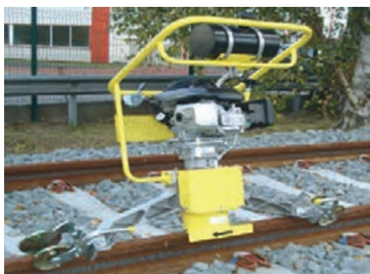
شکل ۱۳- ماشین اتوماتیک سنگ زنی گرده اضافی جوش
