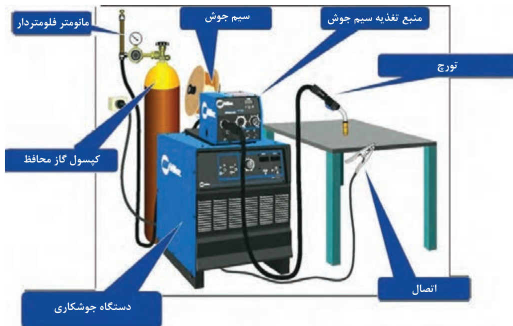
شکل ۶- قسمت های مختلف دستگاه جوشکاری FCAW
