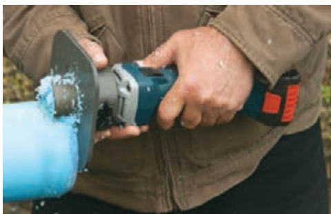
شکل ۲۴- پخ زدن قطعات پلاستیکی برای جوشکاری
