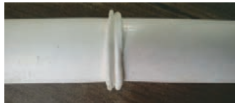
شکل ۲۰- سمت راست) جوشکاری لوله بدون بوشن - سمت چپ) جوشکاری لوله با استفاده از بوشن
