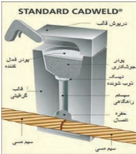
شکل ۲۷- تجهیزات جوشکاری احتراقی
