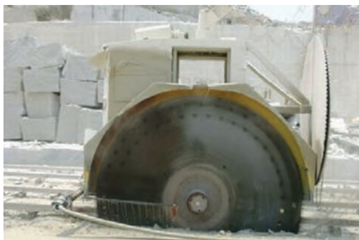
دستگاه دیسک برنده در حال برش سنگ
