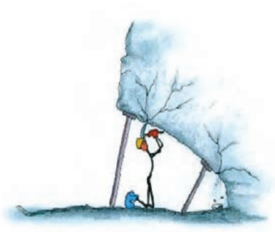
ایجاد زیر برش با نصب وسیله نگهدارنده
