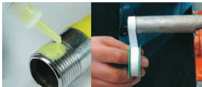
لوازم آببندی اتصالات و لوله‌ها
