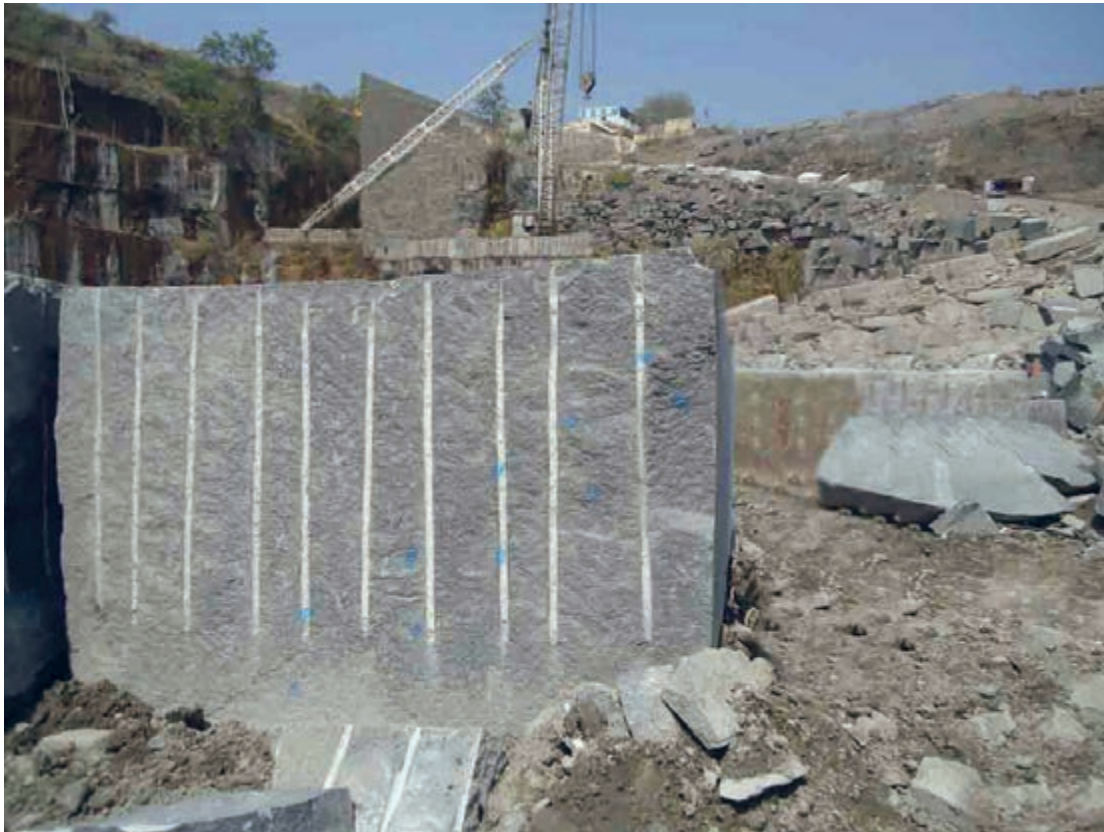
بلوک استخراج شده با روش چال موازی مراحل استخراج با روش چال‌های موازی
