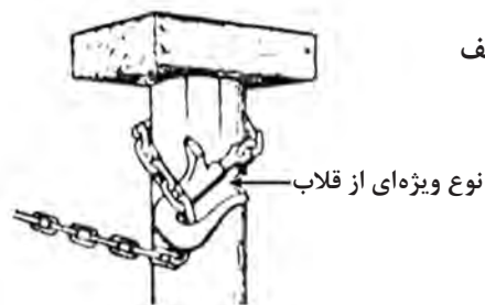
(الف) نحوه بستن قلاب به دور پایه
