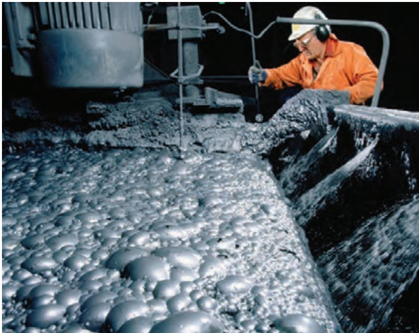
شکل ۲۹- کنترل ابعاد و سطح کف در سلول فلوتاسیون
