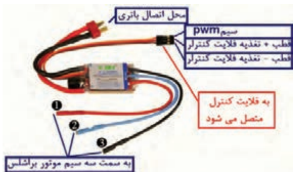
کنترل کننده سرعت (ESC)
