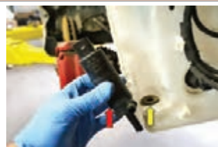
شکل ۳۰- مراحل تعویض پمپ شیشه شوی
