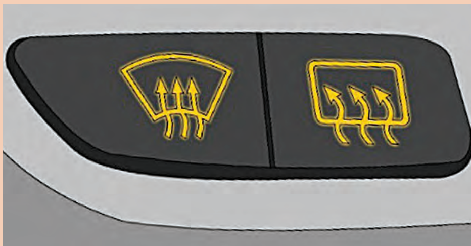
شکل ۳۳- علائم کلید بخار زدا
