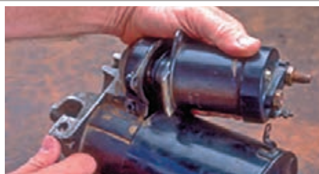
- خارج کردن اتوماتیک استارتر
