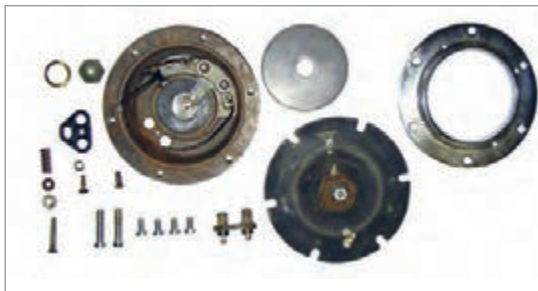
شکل ۴۵- اجزای داخلی بوق الکترومغناطیسی
