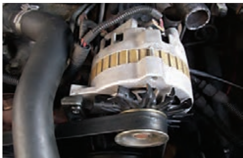
بررسی تسمه از نظر خرابی، پارگی
