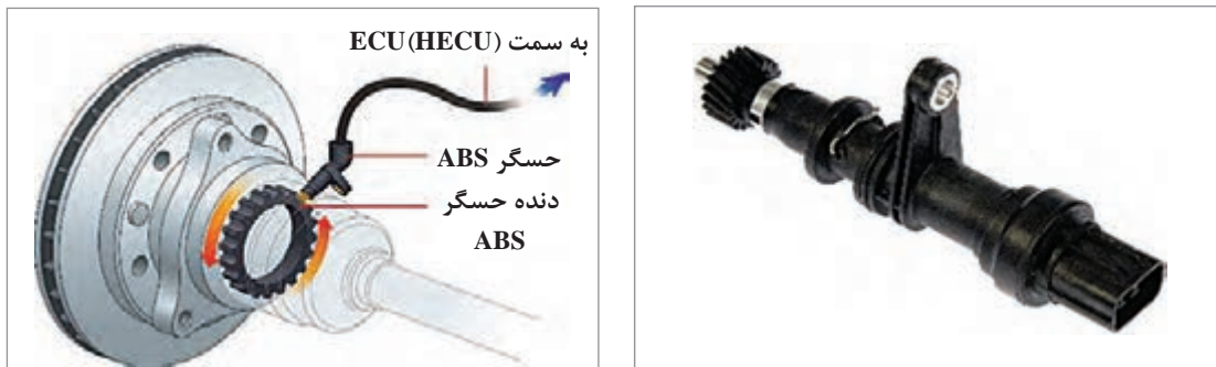
شکل ۱۶- حسگر سرعت خودرو از نوع القایی
