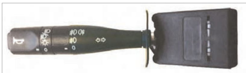
شکل ۱۳- نوعی کلید ترکیبی روشنایی
