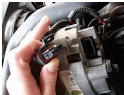
بررسی ظاهری کانکتورها از نظر شکستگی
