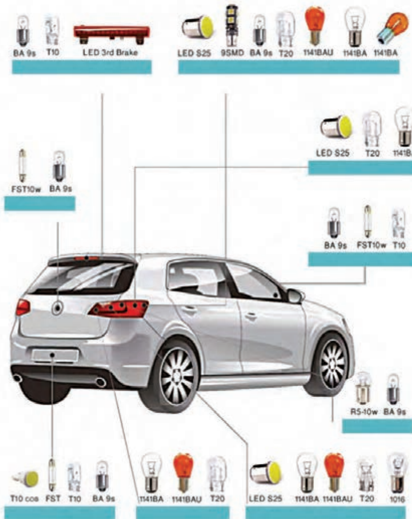
ادامه شکل ۴- انواع لامپ مورد استفاده در خودرو
