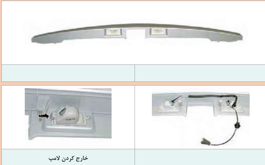
شکل ۳۵- روش باز کردن و بستن چراغ پلاک
