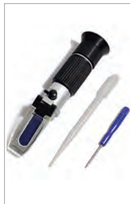
رفلکتومتر، اندازه‌گیری جرم حجمی الکترولیت
