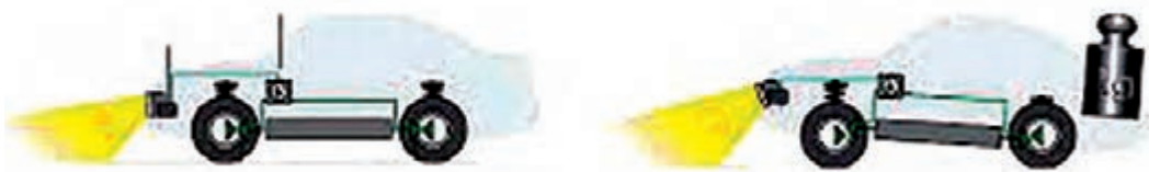
شکل ۹- دلیل نیاز به سیستم تنظیم ارتفاع چراغ
