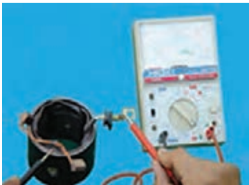
- آزمایش اتصال بدنه بالشتک ها
