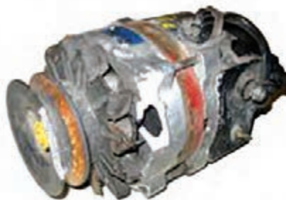
بررسی بدنه از نظر شکستگی یا صدا
