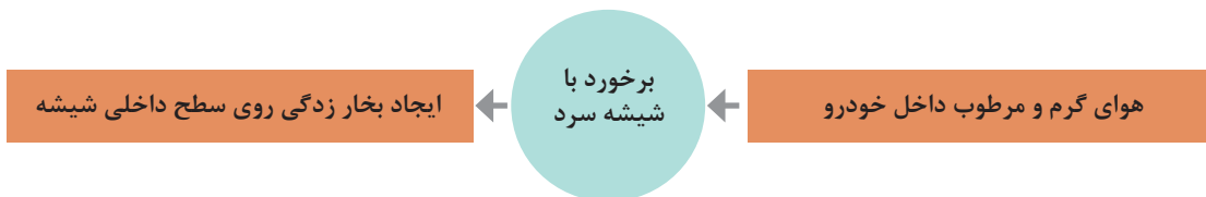
شکل ۳۲- فرایند بخار زدگی شیشه‌ها
