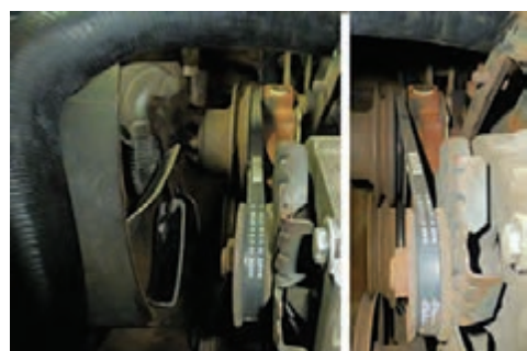
بررسی ناهم‌راستایی تسمه و میزان کشش
