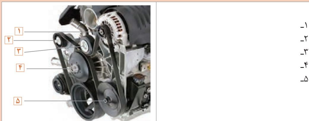
شکل ۵۶- اجزای محرک آلترا تاور (روش انتقال گشتاور به پولی)
