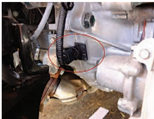
شکل ۱۸- حسگر دور موتور و محل بستن آن
