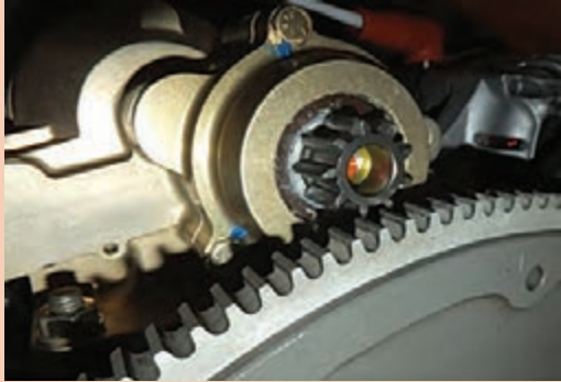
شکل ۱۰۰-ارتباط دنده فلاپیول با دنده استارتر
