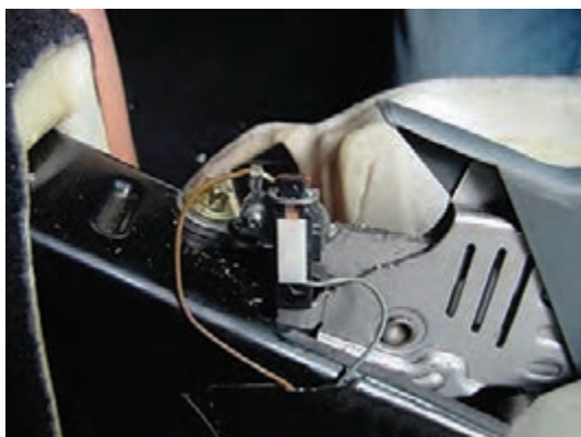
شکل ۲۴- میکروسوییچ ترمز دستی و محل بستن آن
