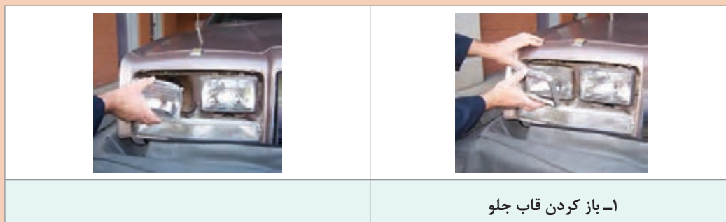
شکل ۳۳- نکات مهم باز کردن، تعمیر و بستن مجموعه چراغ جلو (ساده)
