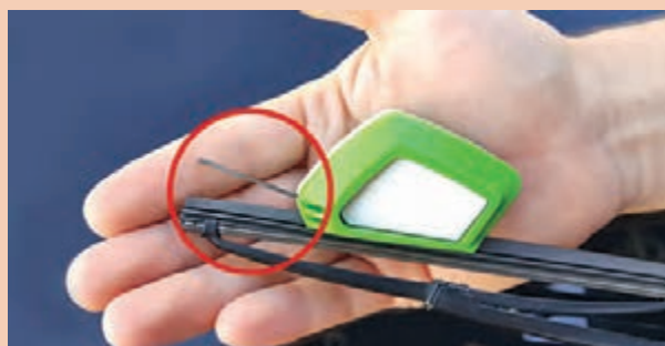
شکل ۲۵- کاتر لایه‌بردار تیغه
