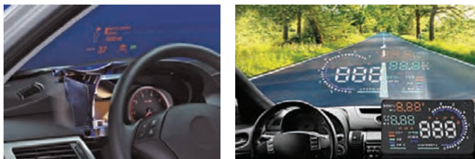
شکل ۸ و ۹- نمایشگر Head up
