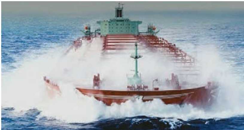
شکل ۶- مقاومت پاشش آب به واسطه برخورد شناور به آب دریا
