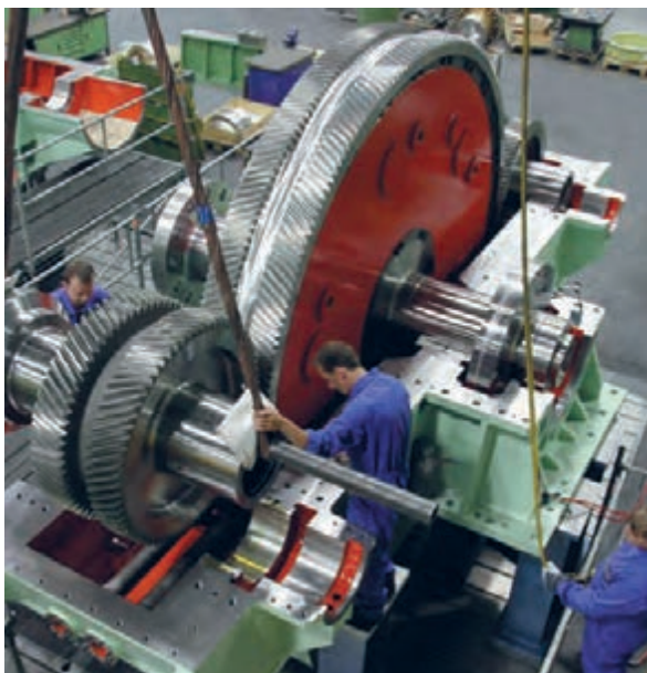
شکل ۴- یک نوع جعبه دنده بزرگ برای انتقال قدرت توربین‌های بخار کشتی به پروانه کشتی
