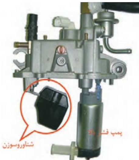
شکل ۸- مجموعه داخل مخزن تفکیک بخار
