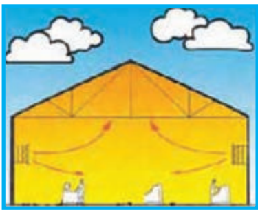
تصویر ۱-۲- مقایسه‌ی سیستم‌های گرمایشی جابه‌جایی و تابشی
