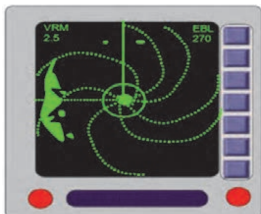
شکل ۱۸- اکوی ناشی از تداخل راداری
