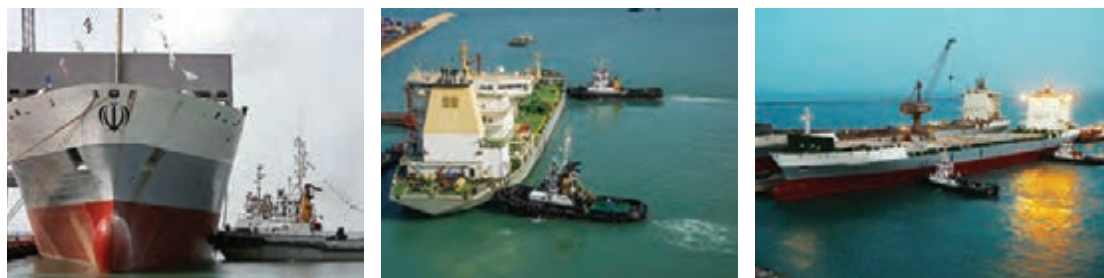
شکل ۲۹- عملیات یدک‌کشی پهلوپهلو
