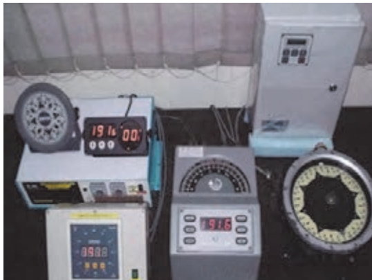
شکل ۳- قطب‌نمای الکتریکی (جایرو) و متعلقات آن
