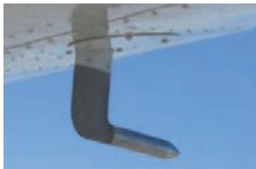
شکل ۲۴- نشان‌دهنده ولوله پیتوت (رادمتر)
