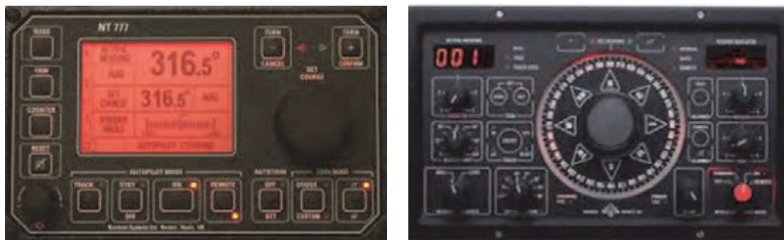
شکل ۲۷- قسمت قرار دادن راه (Set Course Unit)
