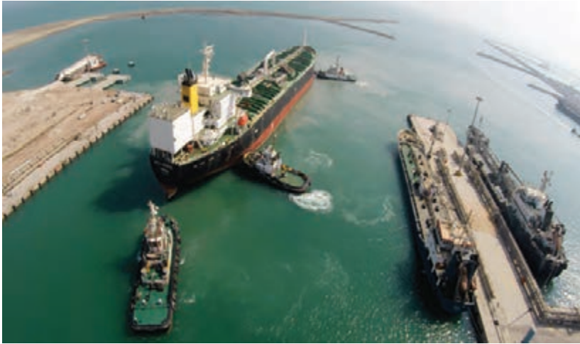
شکل ۲۰- عملیات پهلو دهی کشتی به اسکله
