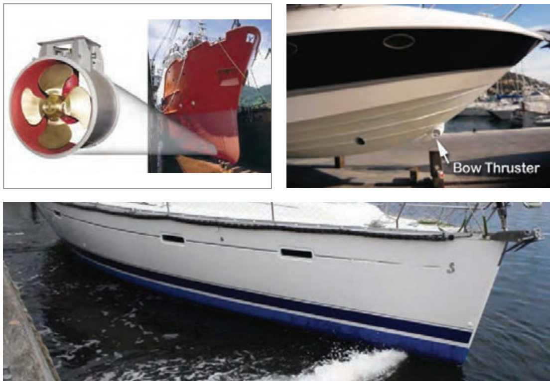
شکل ۶- پروانه‌های جانبی سینه شناور (Bow Thruster)
