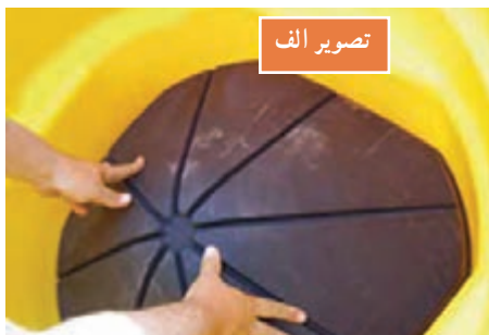
شکل ۲۲- چیدمان بشکه‌ها و قرار دهی مخروط درونی
