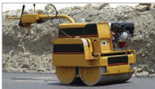
شکل ۴۱- غلتک دستی برای تراکم آسفالت
