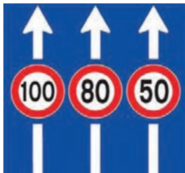
شکل ۳۴- تابلوی حداکثر سرعت در آزاد راه
