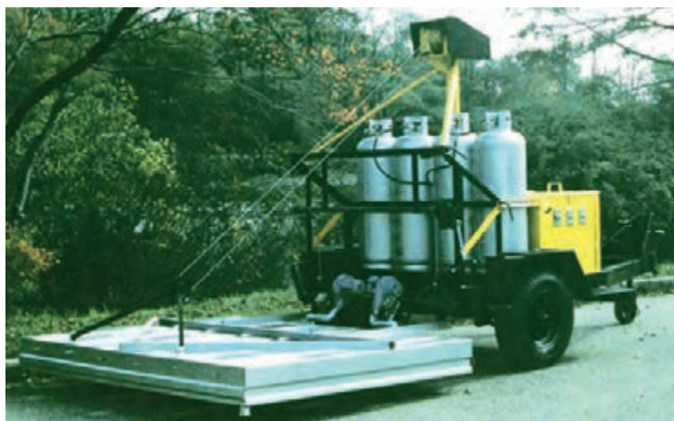
شکل ۴۷ - تجهیزات صفحه گرمکن
