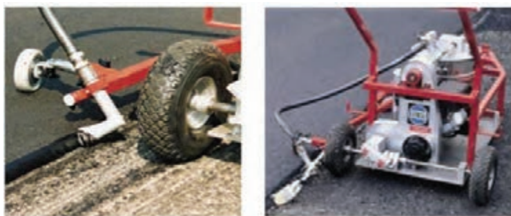
شکل ۴۹- دستگاه مخصوص اندود سطح دیواره آسفالت موجود با مواد چسبنده
