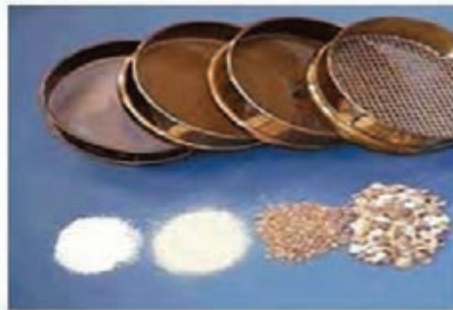
شکل ۷- سری الک های استاندارد دانه بندی خاک
