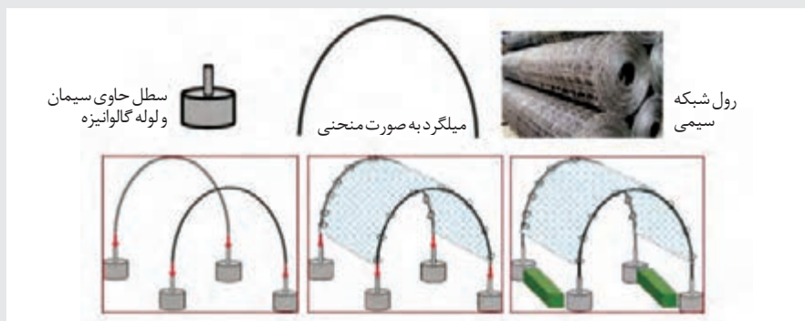
مراحل ساخت تونل سبز توسط شبکه‌های سیمی
