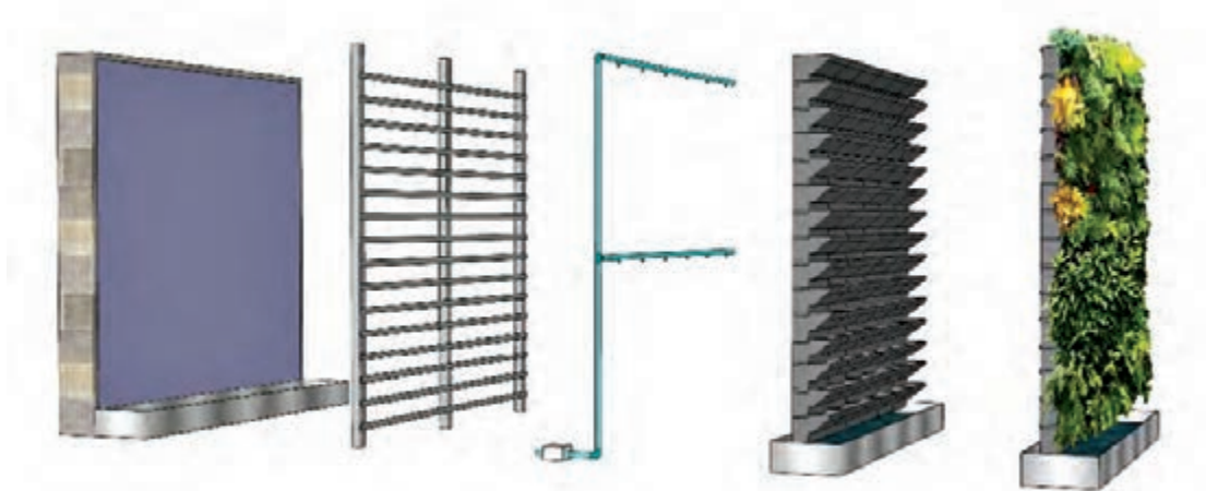
نحوه اتصال گلدان‌های کاشت روی شبکه‌های فلزی
