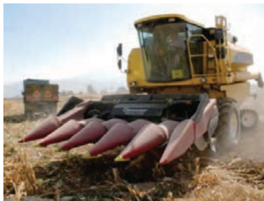
شکل ۱۲- کمباین دارای هد مخصوص برداشت ذرت دانه‌ای
