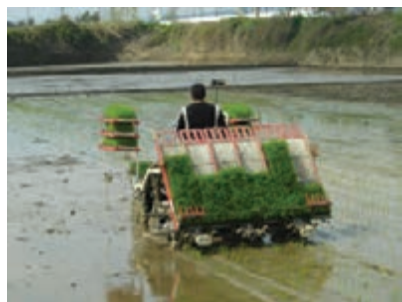
شکل ۳- نشاکاری برنج با نشاکار
