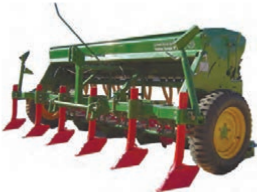
شکل ۷- خطی کار دارای فاروئر
