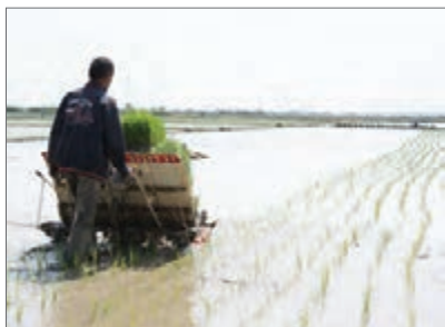
شکل ۲۱- نشاکاری با نشاکار
