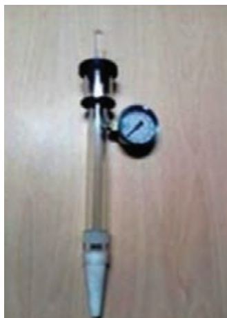
تانسیومتر آنالوگ مدل آب ۳۰ سانتی‌متری
