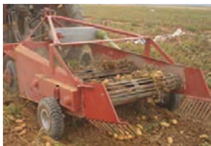
شکل ۲۶- برداشت و جمع‌آوری سیب‌زمینی با دستگاه غده‌کن
