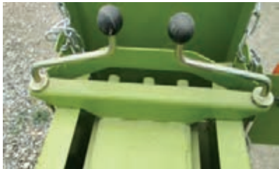
شکل ۲۳- شکل اهرم‌های تنظیم فشردگی و تغییر وزن بسته
