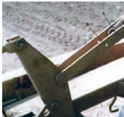
شکل ۲۹- تنظیم فنر شناوری
