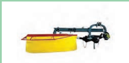
شکل ۱۰- حفاظ دستگاه دروگر استوانه‌ای و بشقابی
