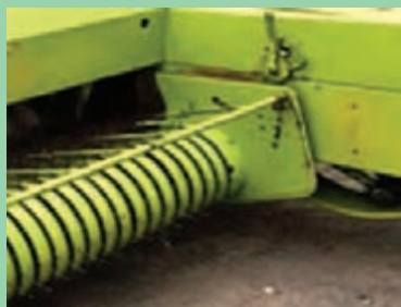
شکل ۲۰- تنظیم ارتفاع بردارنده
