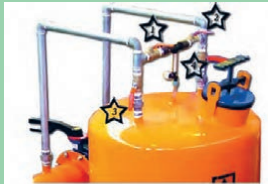
شکل ۳۲- اتصال مخزن کود به لوله اصلی ۱- شیرهای برگشت (By pass)، ۲ و ۳- شیرهای ورودی و خروجی مخزن ۴- شیر فلکه روی لوله اصلی
