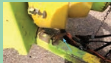
شکل ۱۶- پین تغییر وضعیت دستگاه از حالت حمل و نقل به حالت کار و بالعکس
