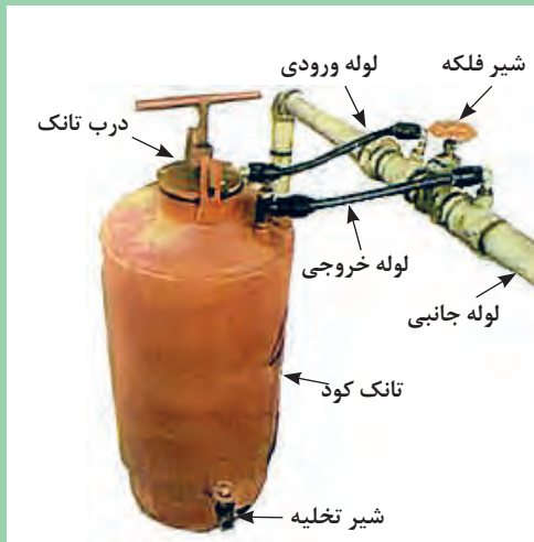
شکل ۳۳- اجزای سیستم توزیع کود
