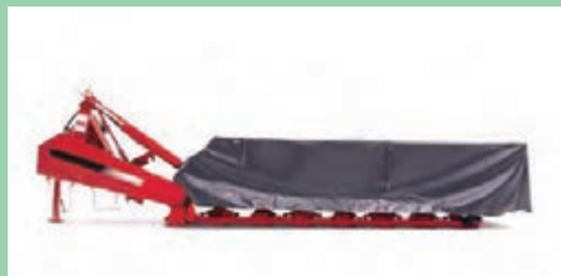
شکل ۱۰- حفاظ دستگاه دروگر استوانه‌ای و بشقابی
