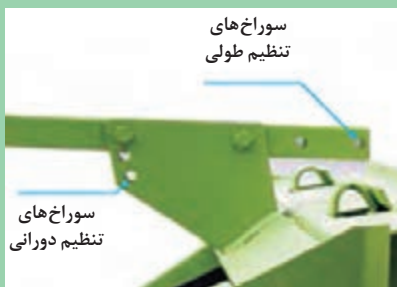
شکل ۵۱- هدایت کننده علوفه و پیچ‌های تنظیم آن
