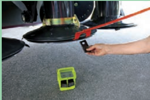
شکل ۲۰- نحوه تعویض تیغه در دروگر استوانه‌ای
