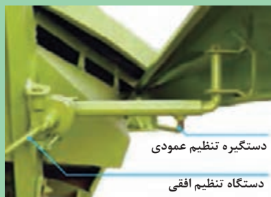
شکل ۵۰- دستگیره‌های تنظیم صفحه جداکننده محافظ علوفه
