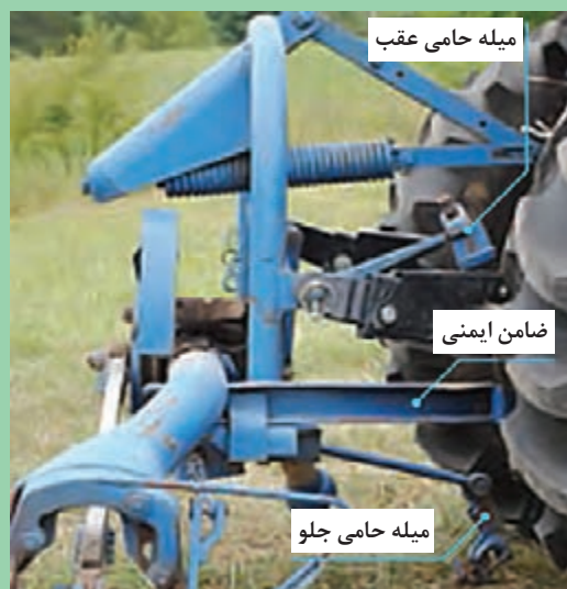
شکل ۲۱- نحوه اتصال دروگر شانه‌ای به تراکتور
