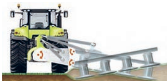
شکل ۱۲- حالت‌های کاری دروگر استوانه‌ای در شیب
