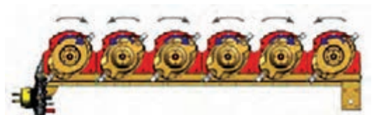
شکل ۸- جهت چرخش بشقاب‌ها در دروگر بشقابی
