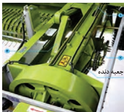
شکل ۱۲- مسیر انتقال توان در دستگاه بسته‌بند
