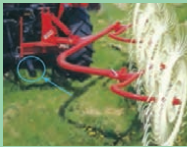
شکل ۹- اتصال شانه خورشیدی به تراکتور
