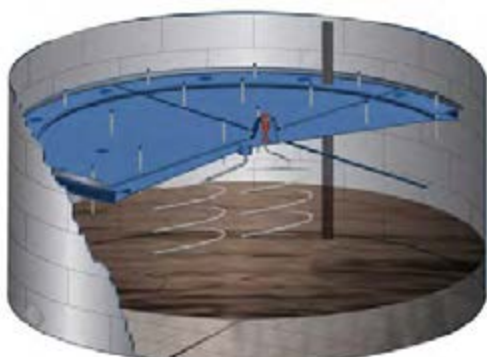
شکل ۴-۱۷- مخازن سقف شناور بیرونی
