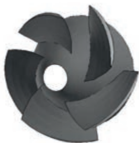
شکل ۹-۳- پروانه با جریان مختلط
