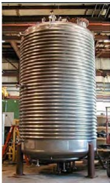
شکل ۵-۴- راکتور ناپیوسته صنعتی با سامانه گرمایی
