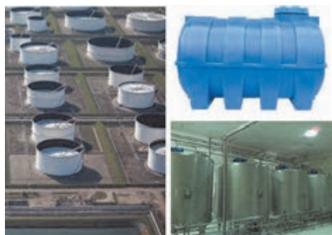
شکل ۴-۱۴- مخزن ذخیره‌سازی استوانه‌ای کم فشار
