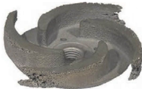
شکل ۳-۱۹- آسیب‌دیدگی پروانه پمپ در اثر پدیده کاویتاسیون
