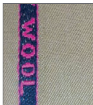
شکل ۱۱- روی پارچه و طرح روی پارچه سرژه ۲ و ۱ صعودی
