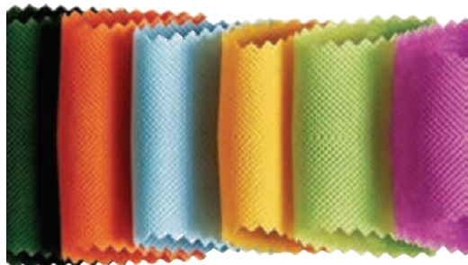
منسوج بی‌بافت تهیه شده از طریق روش حرارتی
