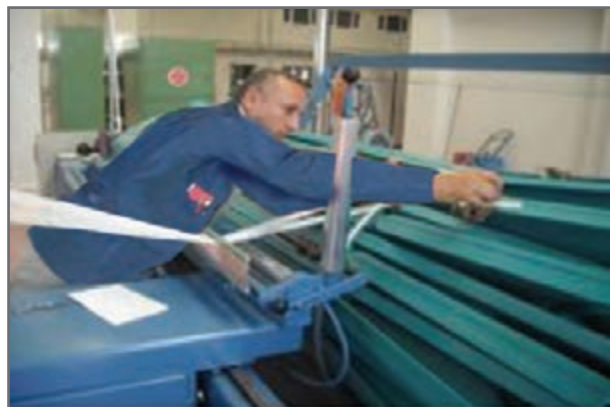
شکل ۲۲- وصل کردن نخ‌ها به میخ روی درام
