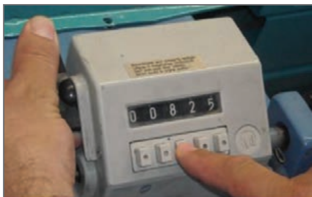
شکل ۱۹- نمونه یک دستگاه مترآژ روی دستگاه چله پیچ
