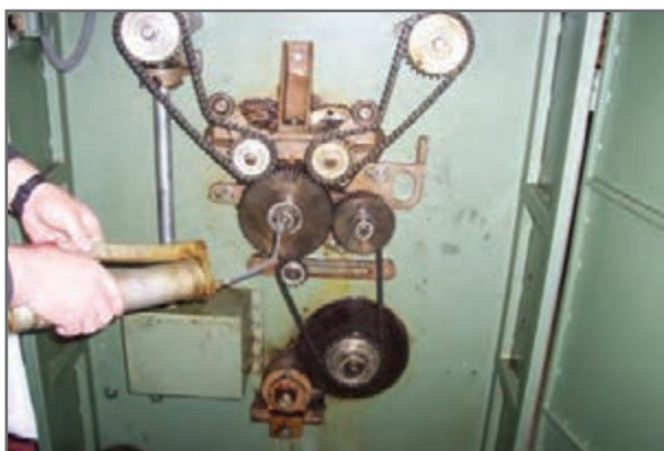
شکل ۱۷- روغن کاری و گریس کاری زنجیرها
