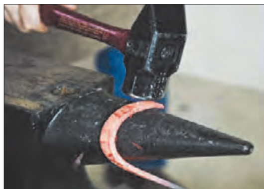
شکل ۳-۴- خمکاری دستی به کمک قالب و چکش
