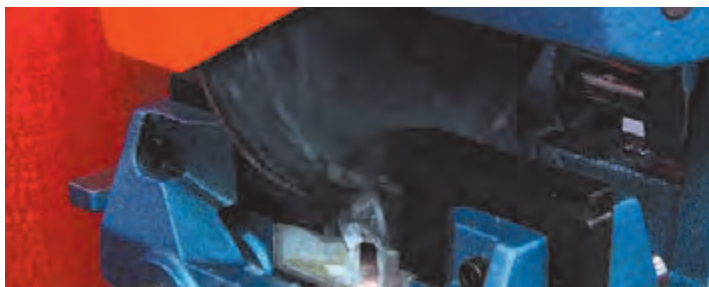
شکل ۱-۱۹- برشکاری با اره آب صابونی
