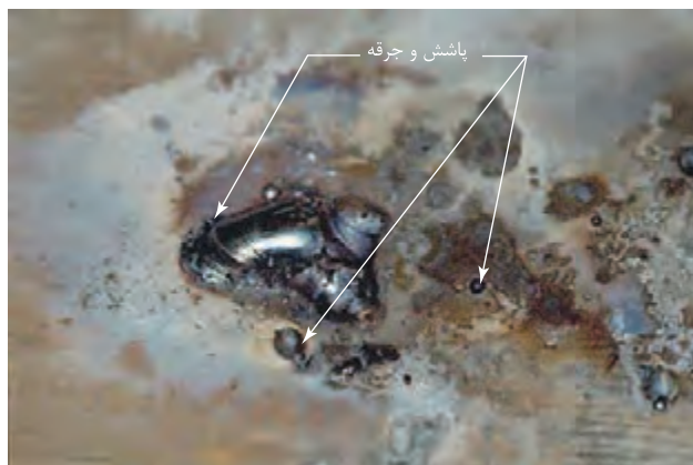
شکل ۴-۳۵: پاشش سخت شده بر روی فلز پایه
