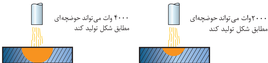
شکل ۴-۴- وابستگی اندازه حوضچه جوش به مقدار انرژی (W)
