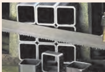
شکل ۱-۱۸- سری بری با استفاده از ااره لنگ
