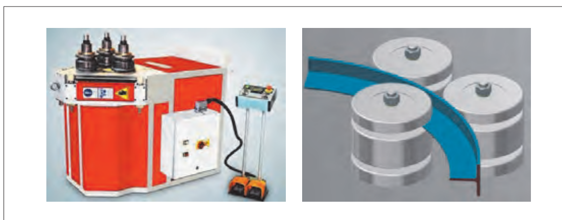
شکل ۳-۱۸- دستگاه خم کن سه غلتکی عمودی
