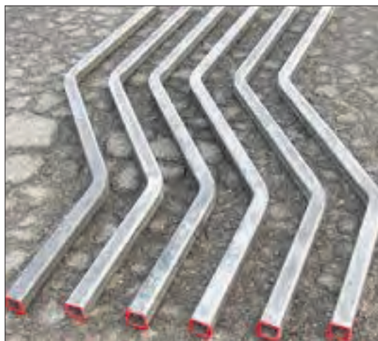
شکل ۳-۲۰- پروفیل با شعاع خم متفاوت
