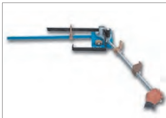
شکل ۳-۵- خمکاری دستی تسمه با ابزار کمکی
