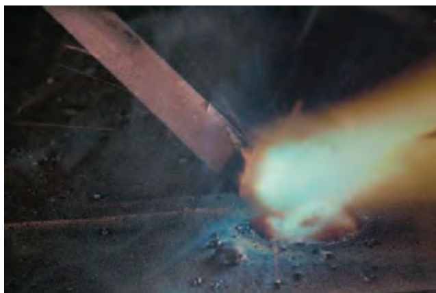
شکل ۴-۳۱- برقراری قوس با الکتروودی که روکش آن کنده شده (عدم برقراری قوس پایدار)
