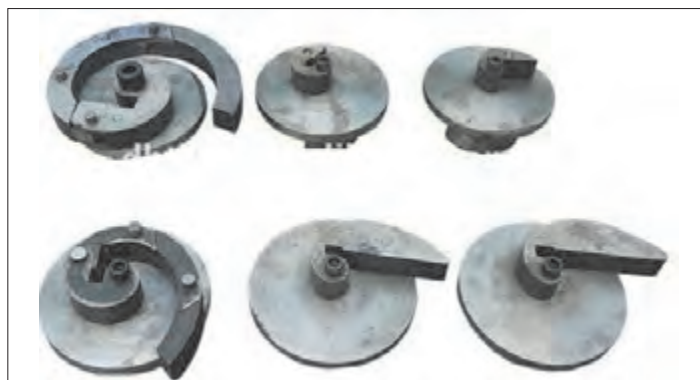
شکل ۳-۲۵- چند نمونه قالب خمکاری با شعاع‌های گوناگون
