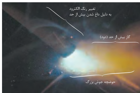
شکل ۴-۳۴- جوشکاری با آمپر بسیار بالا
