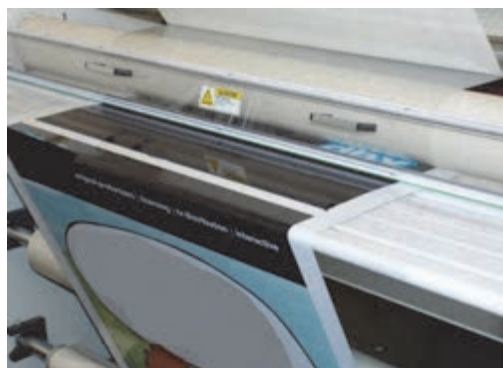
شکل ۴۳ - لمینیتور رول سرد
