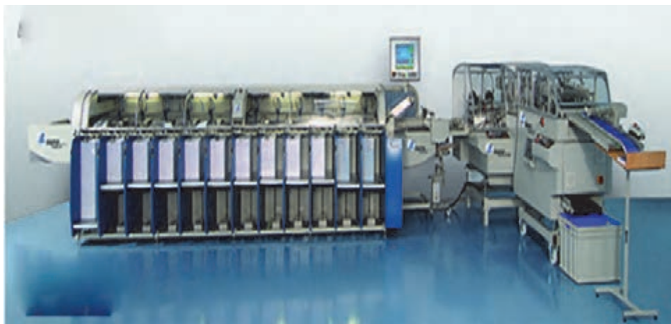
شکل ۶۹- ماشین ترتیب افقی
