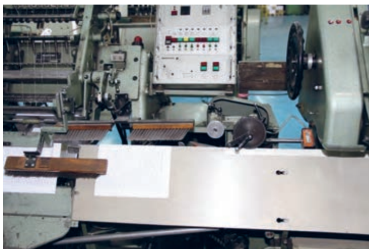
شکل ۲۵- شانه سرعت گیر
