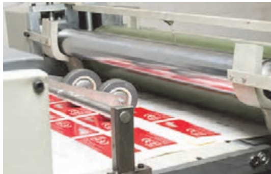
شکل ۸- سیلندر ورنی زنی
