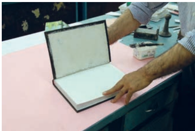
شکل ۵۶- تلفیق جلد و بلوک
