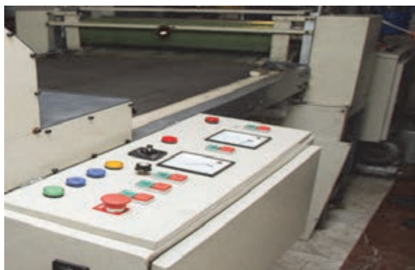
شکل ۹- صفحه انتقال و تنظیم سرعت
