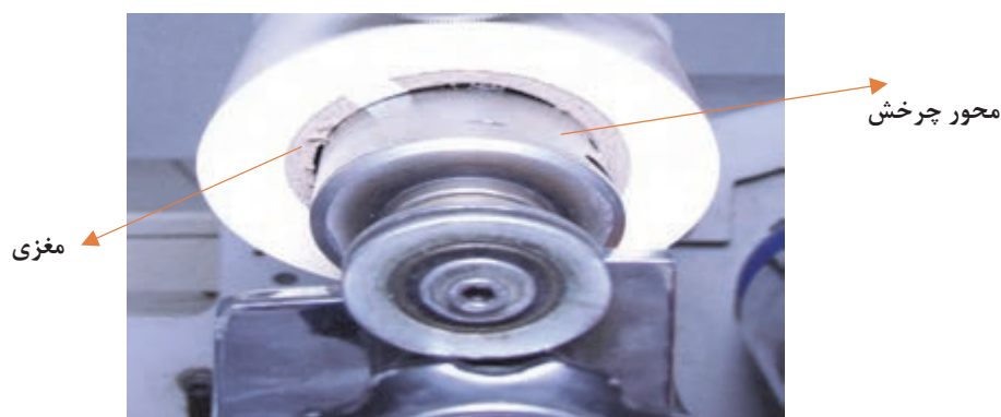
شکل ۲۹- تناسب مغزی سلفون با محور چرخشی دستگاه
