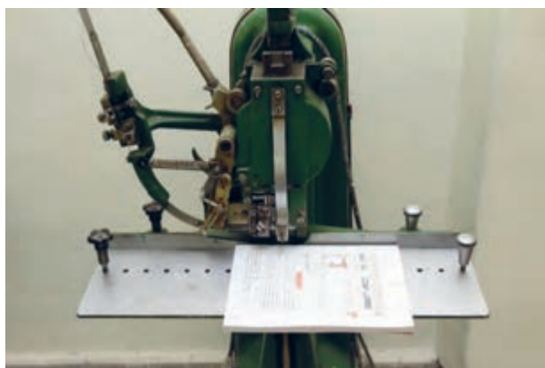
شکل ۱۱- بلوک مفتول دوزی شده از بغل
