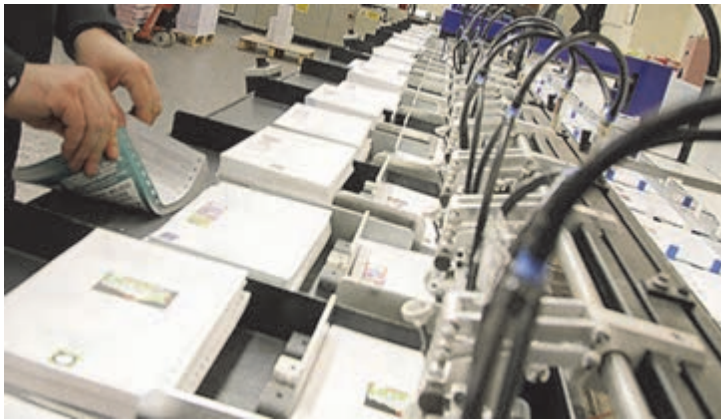
شکل ۷۱- ماشین ترتیب‌کن افقی
