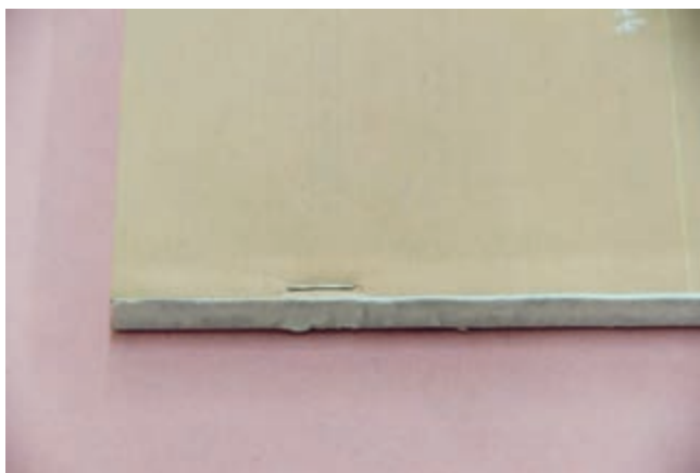
شکل ۱۶- رعایت فاصله مناسب مفتول تا انتهای عطف
