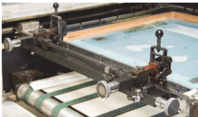
شکل ۱۲- پیچ‌های تنظیم شابلون
