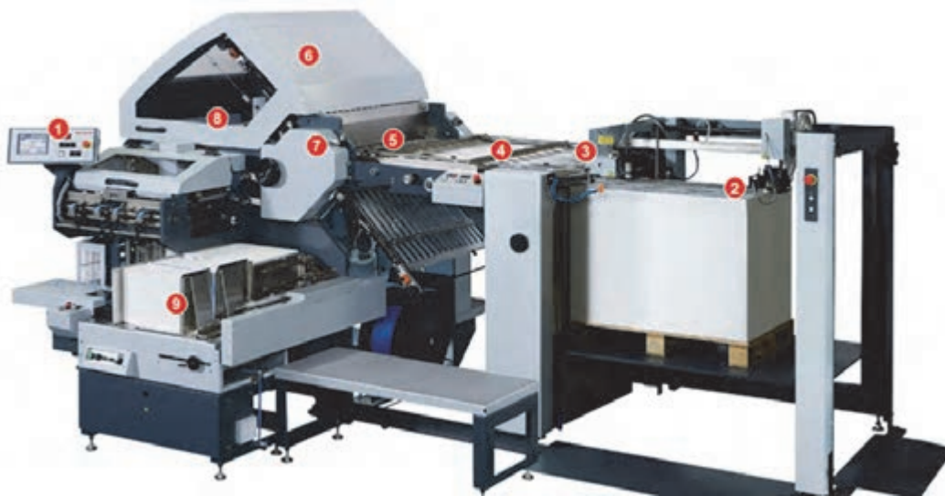
شکل ۵۰- قسمت های اصلی ماشین ورق تاکنی
