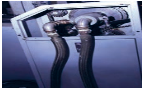
شکل ۲۷- سیستم گرمایشی سیلندر فشار
