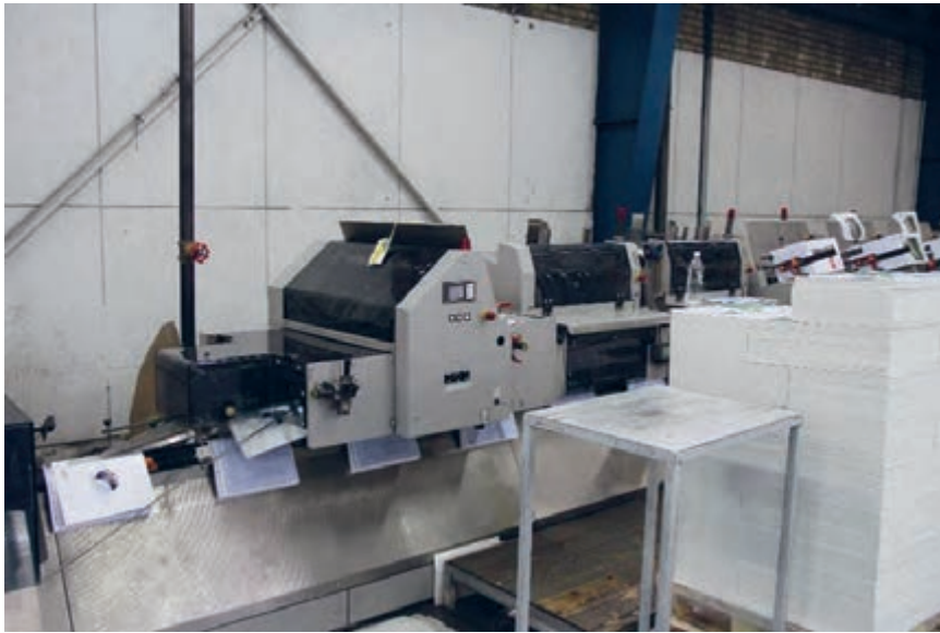
شکل ۴۰- ماشین‌های مفتول‌زنی اتومات
