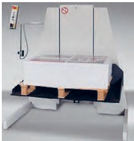
شکل ۱۲- دستگاه بالابر کاغذ
