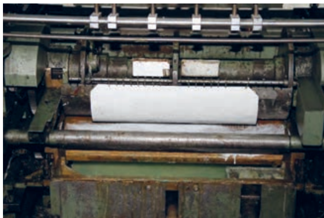
شکل ۴۸- آغشته شدن پوشش به چسب
