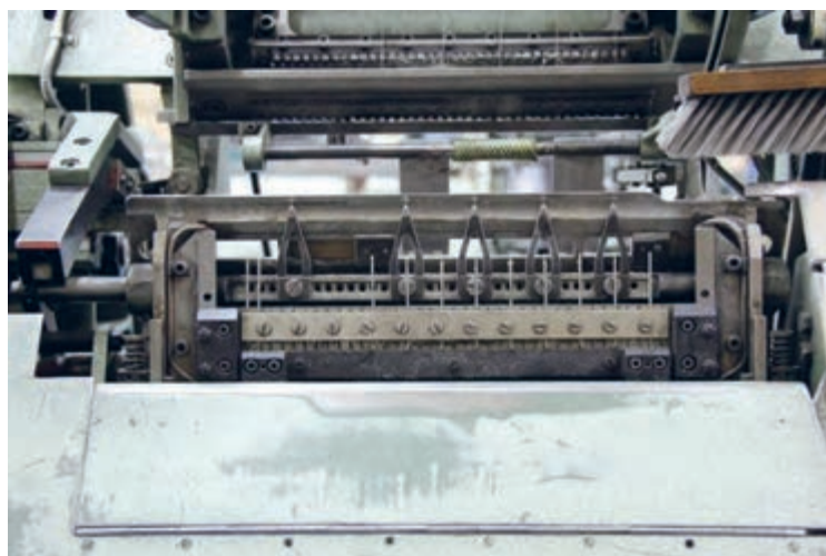
شکل ۲۷- درفش‌ها و زبانه‌ها
