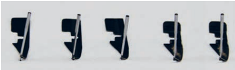
شکل ۳۱- تیغه‌های برش دستگاه دوخت
