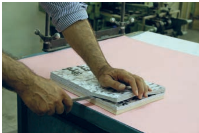
شکل ۱۴- جدا کردن بلوک‌ها از یکدیگر
