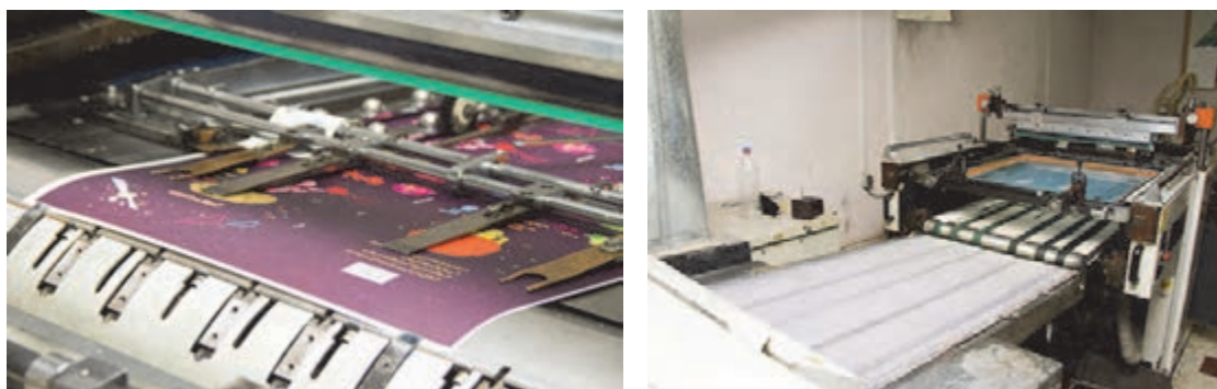
شکل ۱۷- سیستم شابلونی ورنی زنی را به همراه پنجه‌ها و روزنه‌های سیلندر
