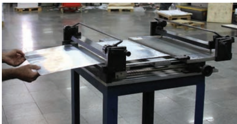
شکل ۶۲- قرار دادن پلیت در دستگاه خم‌کن
