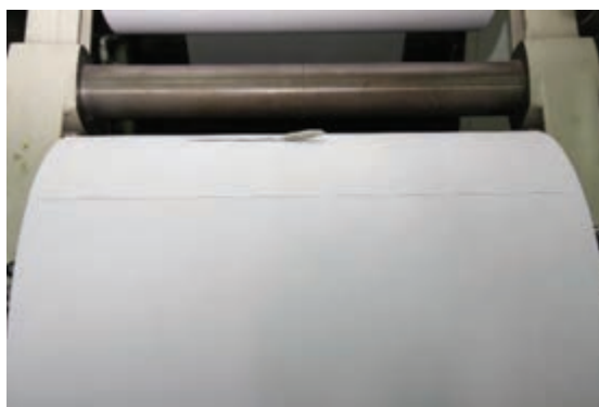
شکل ۱۸- لبه گونیا شده رول
