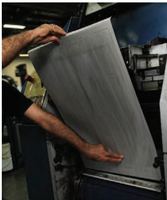
شکل ۵۷- درآوردن پلیت از درون شیار چفت
