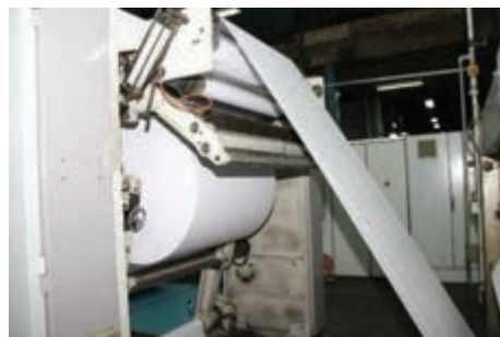
شکل ۹- سیستم عملکرد تغذیه بدون توقف (Splicer)
