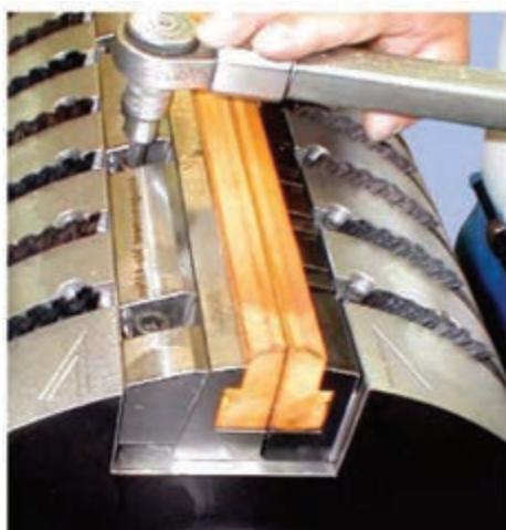
شکل ۳۶- باز و بست با یک تیغه برش
