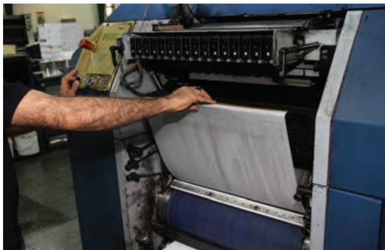
شکل ۵۶- نگاه‌داشتن پلیت برای بازکردن از روی سیلندر
