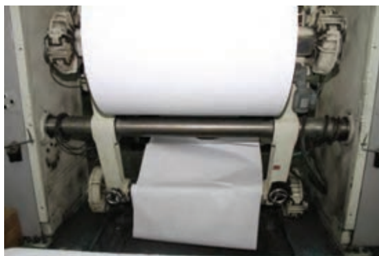
شکل ۱۱- ته رول خارج شده از تغذیه
