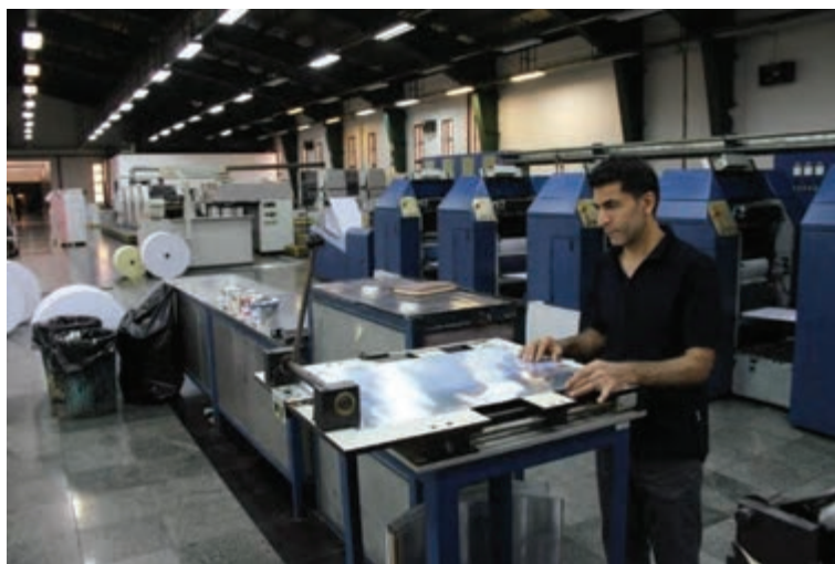
شکل ۵۹- قرار دادن لب کار پلیت در دستگاه پانچ
