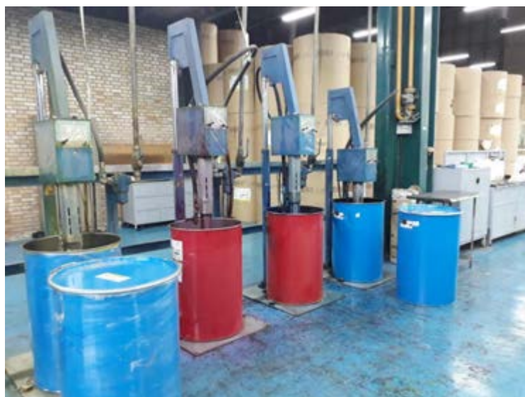
شکل ۷۷- مکانیزم تغذیه خودکار مرکب
