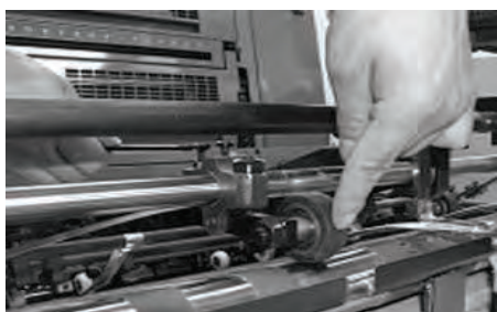
شکل ۳۲- تنظیم فشار قرقره
