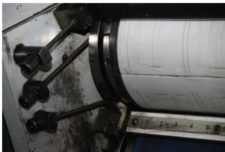
شکل ۵۳- شیار سیلندر (لبه‌های پلیت)
