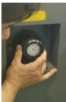
شکل ۳۸- گیج تغییر زاویه سیلندر ترانسفر
