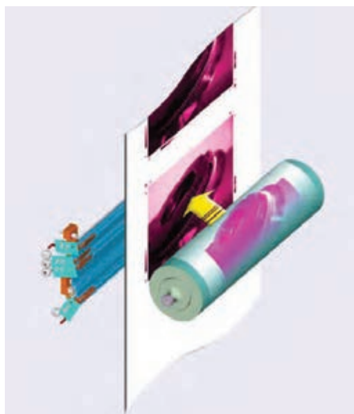
شکل ۳۵- انتقال تصویر روی سطح چاپ شونده
