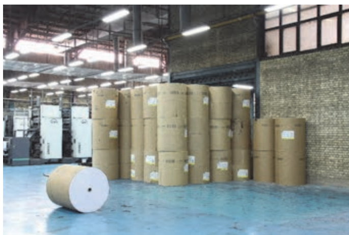
شکل ۱- حالت درست قرار گرفتن رول‌های کاغذ
