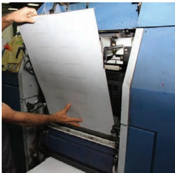
شکل ۶۹- قرار دادن لب کار در شیار سیلندر
