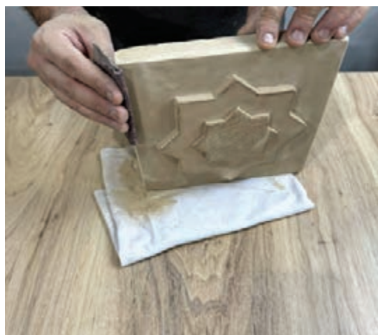
شکل ۶۰- سنباده‌کشی لبه‌های خشت
