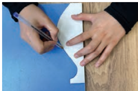
شکل ۳۲- قرار دادن الگوی کاغذی بر روی فوم
