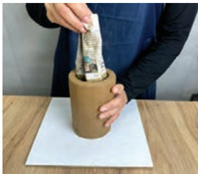
شکل ۶۸- خارج کردن روزنامه از درون استوانه گلی
