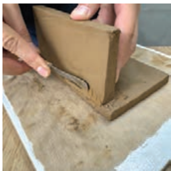
شکل ۸۷- قراردادن فیتیله گلی در محل اتصال و پر کردن درز اتصال
