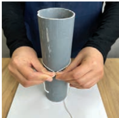
شکل ۵۳- اندازه‌گیری قطر استوانه با نخ
