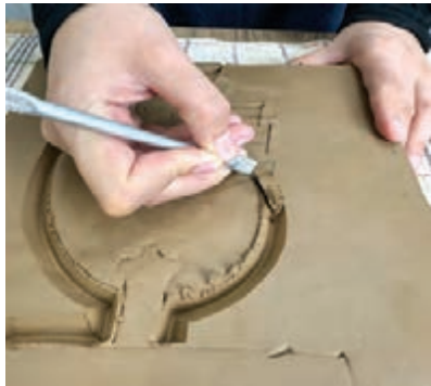
شکل ۵۰- برش شیب‌دار خطوط محیطی
