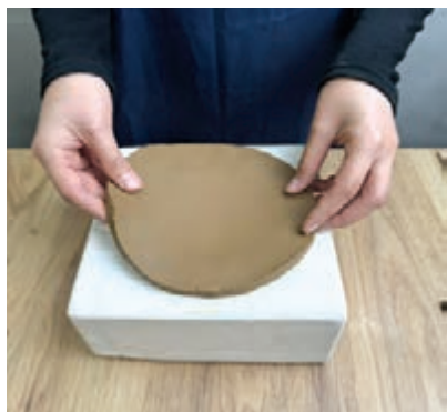
شکل ۲۶- قراردادن ورقه گل درون قالب
