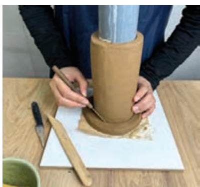
شکل ۶۴- قراردادن استوانه بر روی ورقه گل و علامت گذاری
