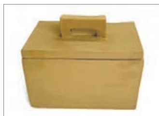
شکل ۹۸- جعبه درب‌دار آماده شده قبل از پرداخت با سنباده
