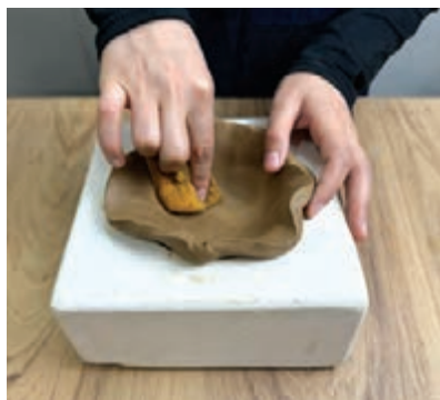
شکل ۲۷- هدایت کردن ورقه گل درون قالب
