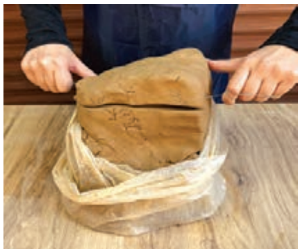
شکل ۷۷- برش گل به وسیله سیم برش
