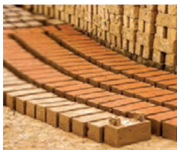
شکل ۷- خشک کردن آجرهای سفالی در فضای باز
