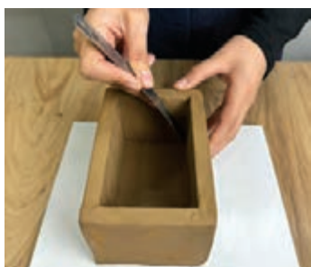
شکل ۹۱- صاف و قائمه کردن درز اتصال در دیواره‌های داخلی
