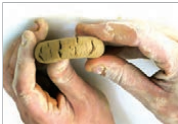
شکل ۷- خم کردن فتیله های گلی به منظور سنجش رطوبت
