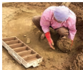
شکل ۶- ساخت آجر درون قالب چوبی
