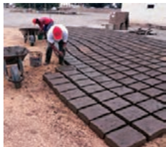
شکل ۵- ساخت خشت گلی در فضای باز
