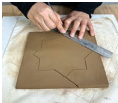
شکل ۴۲- برش طرح روی خشت
