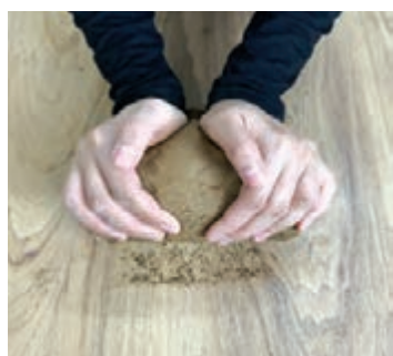
شکل ۳۸- فشار دادن توده گل به سمت پایین
