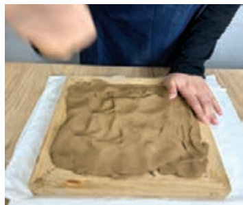
شکل ۲۰- کوبیدن گل درون قالب با دست
