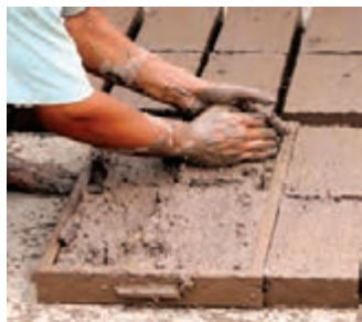
شکل ۵- ساخت خشت گلی در فضای باز
