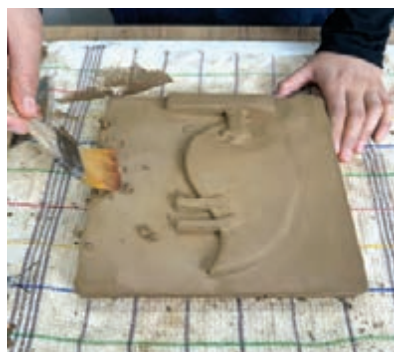
شکل ۵۴- تمیز کردن پلیسه‌های گل با قلم‌مو
