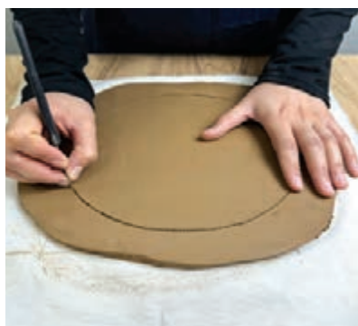
شکل ۲۴- برش الگو بر روی ورقه گل
