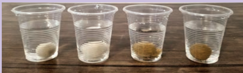
نمونه هایی از گل ارتن ور سفید و قرمز در حالت خشک و پلاستیک
