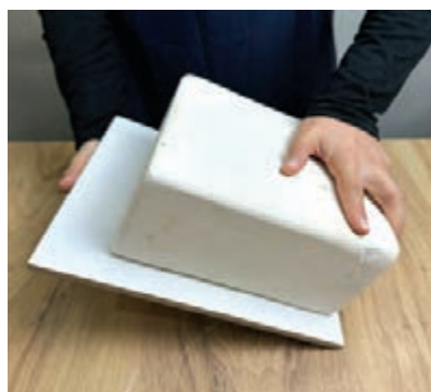
شکل ۳۳- برگردان قالب بر روی سطح زیرکار
