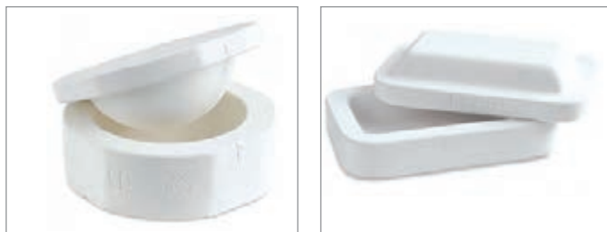
شکل ۲۱- نمونه‌هایی از قالب گچی محدب و مقعر
