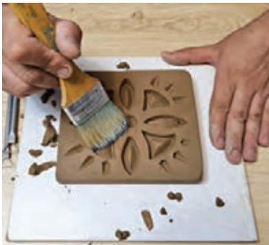
شکل ۳۶- تمیز کردن سطح خشت با قلم‌مو
