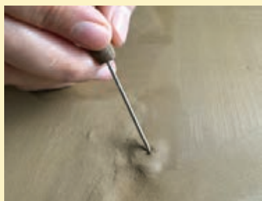
خارج کردن حباب هوا با سوزن
