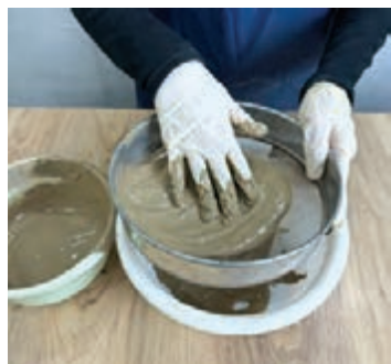
شکل ۲۴- عبور دادن دوغاب گل از الک با کمک دست
