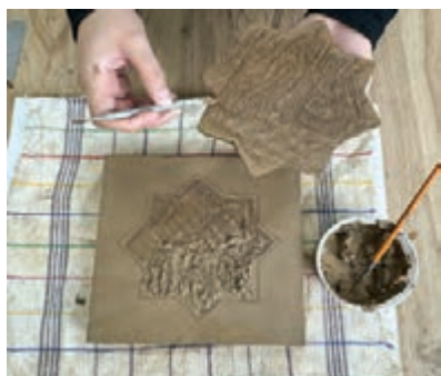
شکل ۴۵- خراش دادن محل اتصال
