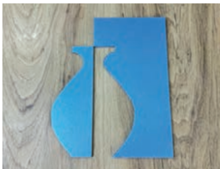
شکل ۳۴- الگوی بریده شده بر روی فوم
