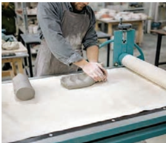
شکل ۷- پهن کردن ورقه گل با دستگاه اسلب رولر
